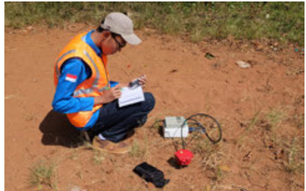
Görsel 11.4: Alan titreşimi ölçme işlemi ve Jeofon
