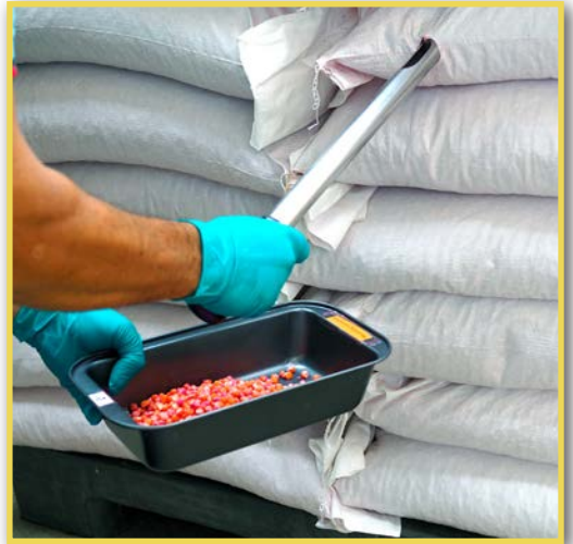
Görsel 1.6: Çuvaldan sonda ile numune alınması
