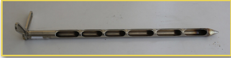
Görsel 1.5: Baston ve kovanlı tip sonda
