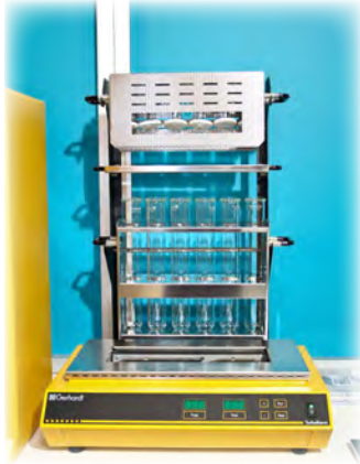
Görsel 7.1: Yakma ünitesi
