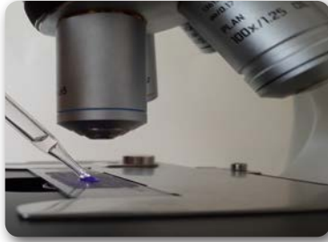
Görsel 9.10: Preparata sedir yağı damlatılması ve İmmersiyon objektifi ile sayım işlemi
