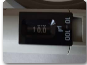
Görsel 9.5: Mikropipetin 0,01 mL ayarlanması
