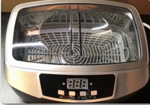
Görsel 2.39: Ultrasonik vibratör cihazının hazır hale getirilmesi
