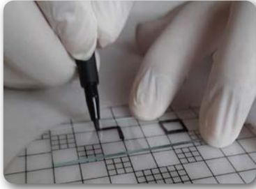
Görsel 9.3: Lam üzerine karelerin çizilmesi
