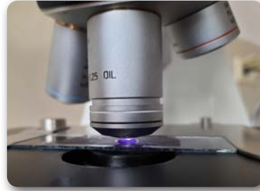
Görsel 9.10: Preparata sedir yağı damlatılması ve İmmersiyon objektifi ile sayım işlemi
