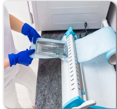
Görsel 2.14: Paketlerin ısı uygulaması ile kapatılması
