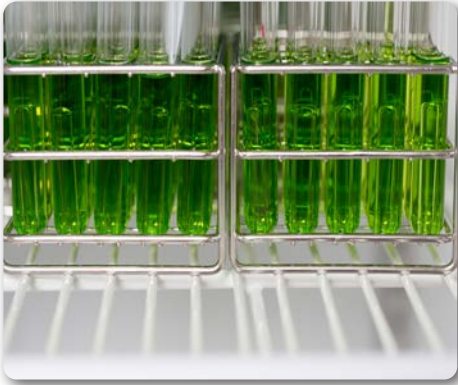
Görsel 10.5: Koliform kolonilerinin doğrulanması amacıyla pasaj yapılan BGLB broth tüpleri
