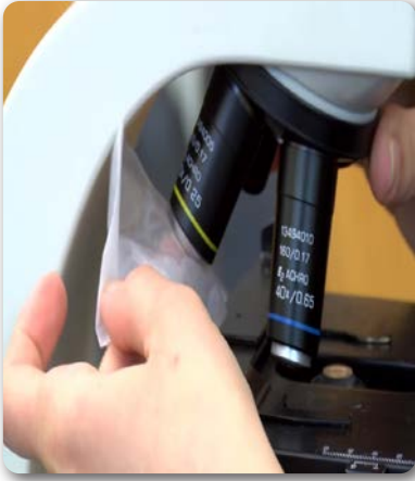
Görsel 7.2: Mikroskop objektiflerinin temizliği
