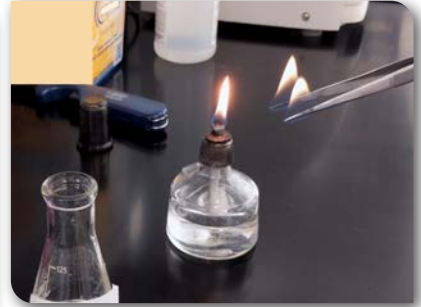
Görsel 2.16.c: Pensetin üzerindeki alkolün yanarak uzaklaşması
