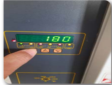
Görsel 2.20: Etüvün sıcaklık ve süre ayarlarının yapılması
