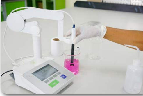
Görsel 3.6: pH metre ile ölçüm
