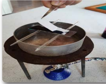
Görsel 6.25: Kurutma kâğıdının preparat üzerine konulması
