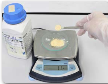
Görsel 3.8: Dehidre besiyerinde tartım işlemi
