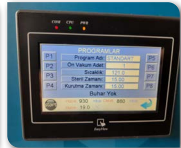
Görsel 2.23: Otoklavda sıcaklık ve süre ayarlarının yapılması
