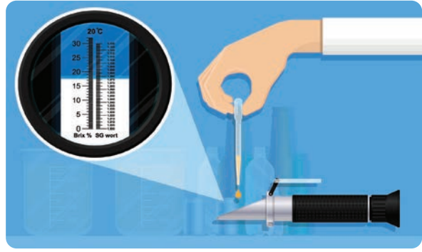
Görsel 9.23: El tipi refraktometre kısımları ve ölçüm
