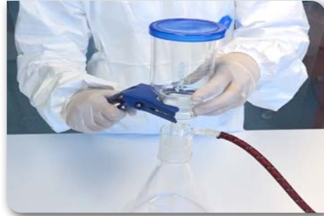
Görsel 2.38: Filtrasyon düzeneğinin kontrol edilmesi
