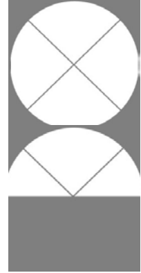
Görsel 9.30: Abbe refraktometre başlangıç ve okuma anının görüntüsü
