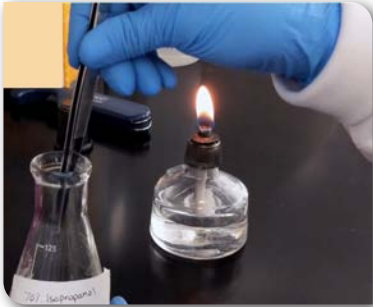
Görsel 2.16.a: Steril edilecek pensetin alkole daldırılması
