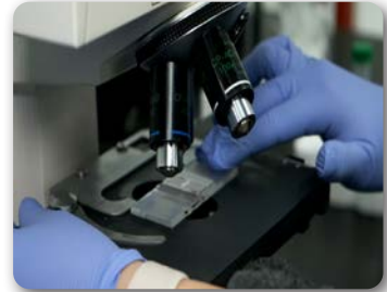
Görsel 9.19: Thoma laminin mikroskoba yerleştirilmesi
