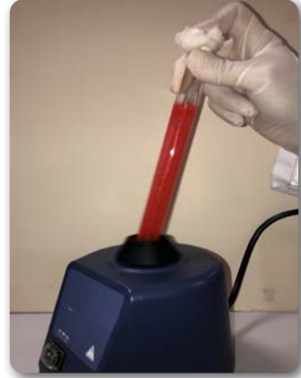
Görsel 4.11: Vorteks cihazı ile homojenizasyon
