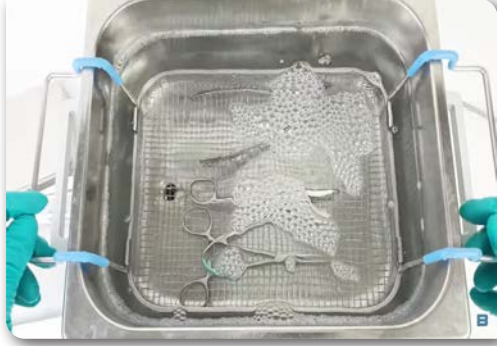
Görsel 2.43: Malzemelerin cihazdan çıkarılması
