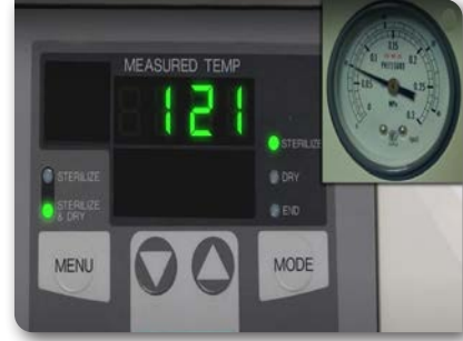
Görsel 2.24: Otoklavda sterilizasyon anında göstergeler
