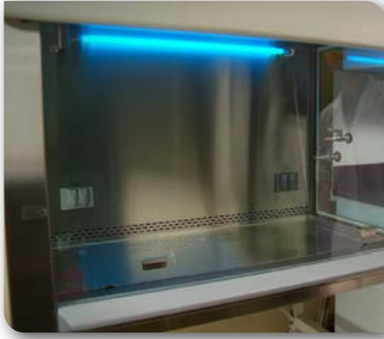
Görsel 2.30: UV lambasının yakılması
