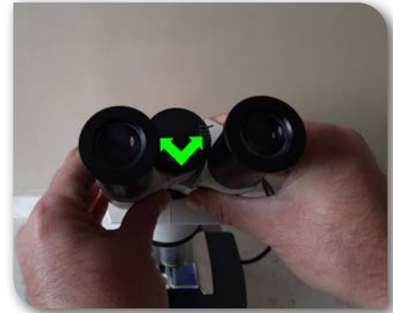
Görsel 7.6: Okülerde göz aralığı mesafesinin ayarlanması
