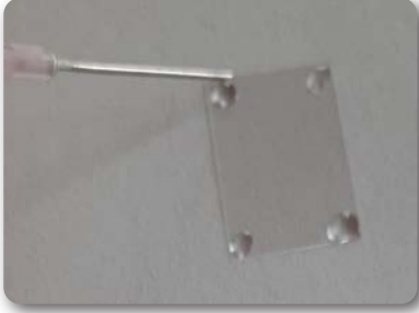
Görsel 7.19: Lamelin köşelerine vazelin sürülmesi
