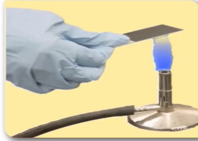
Görsel 6.6: Preparatın alevden geçirilerek fikse edilmesi
