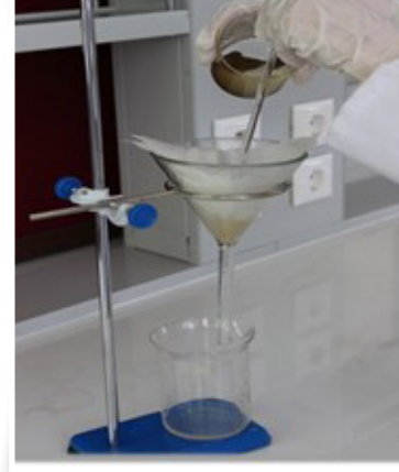
Görsel 2.16: Süzme işlemi ve çökeleğin filtre kâğıdına aktarılması
