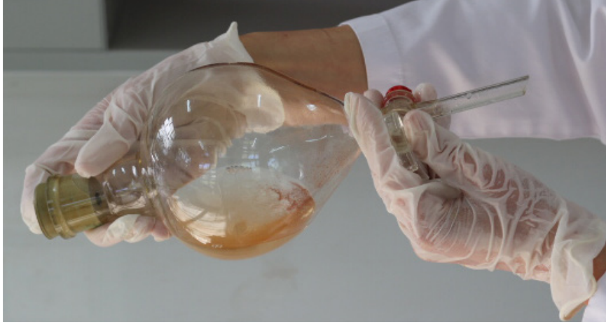
Görsel 2.23: Ayırma hunisini, ekstraksiyon sırasında uygun tutma metodu
