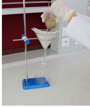
Görsel 2.16: Süzme işlemi ve çökeleğin filtre kâğıdına aktarılması
