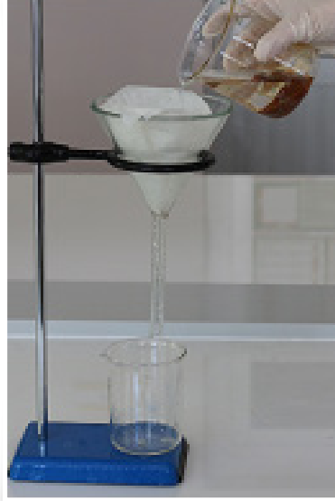
Görsel 4.2: Süzme işlemi ve çökeleğin süzgeç kâğıdına aktarılması
