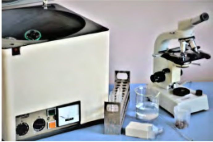
Görsel 7.19: Telemann metodu ile çöktürmede kullanılan araç gereç
