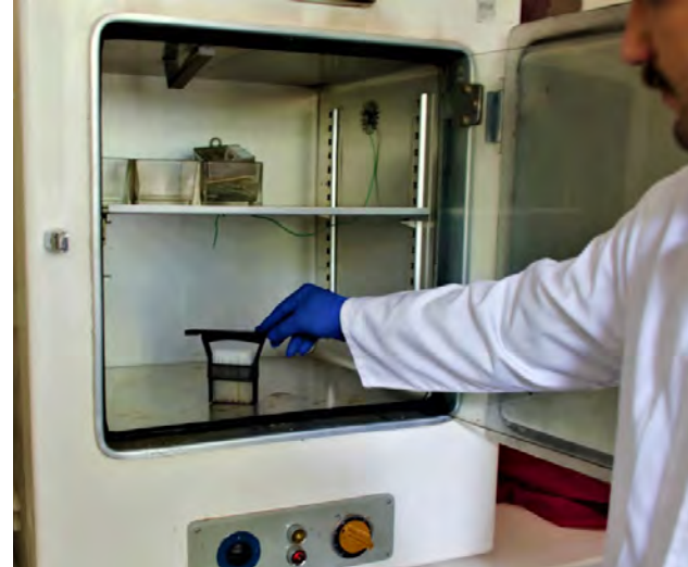
Görsel 6.13: Taşıma sepetlerinin etüve yerleştirilmesi
