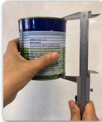
Görsel 2.14: Kutunun dış yüksekliğinin ölçümü
