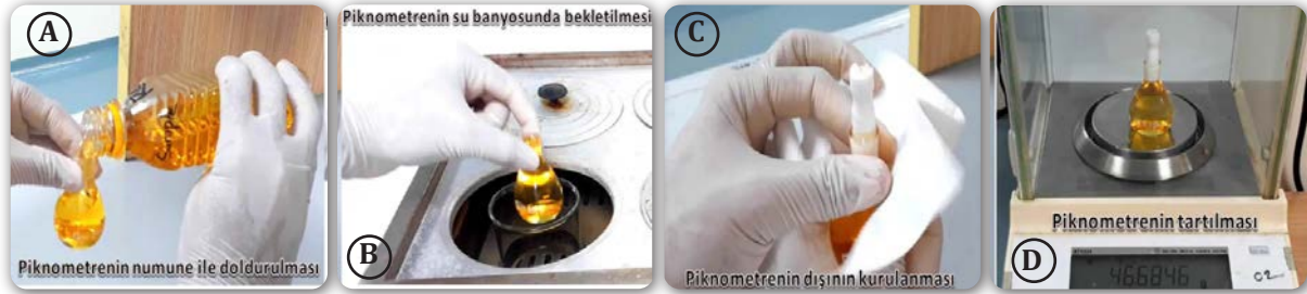
Görsel 5.2: Piknometre ile özgül ağırlık tayini işlemleri (A Piknometrenin numune ile doldurulması, B piknometrenin su banyosunda bekletilmesi, C piknometrenin dış yüzeyinin kurutulması, D Piknometrenin tartılması)
