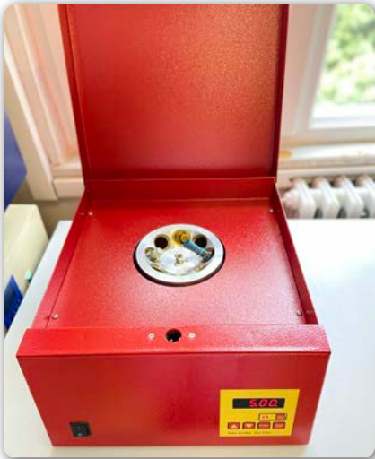
Görsel 6.16: Bütrometrenin gerber santrifüjüne yerleştirilmesi
