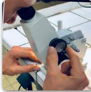
Görsel 1.11: Abbe refraktometresinin kalibrasyonu
