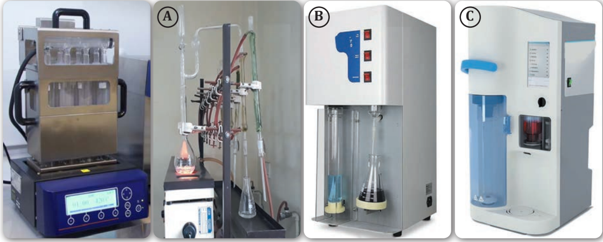
Görsel 4.8: Kjeldahl cihazı yaş yakma ünitesi ve damıtma ünitesi (manuel (A), yarı otomatik (B), tam otomatik (C))
