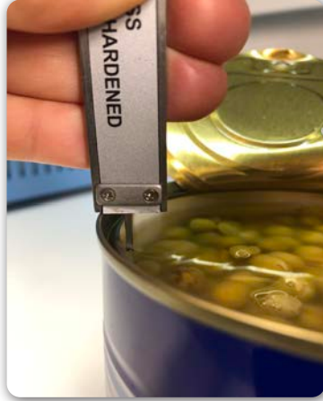
Görsel 2.17: Kumpasla brüt tepe boşluğu ölçümü
