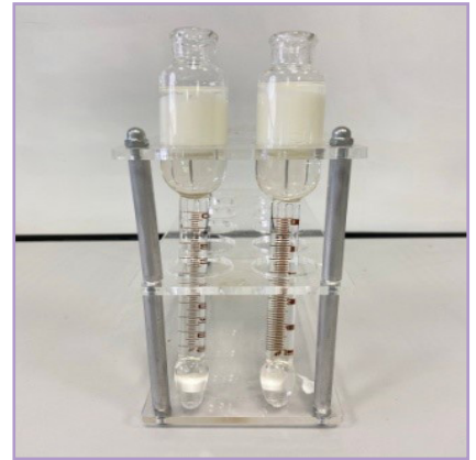
Görsel 6.14: Bütirometreye asit, numune, alkol ilavesi
