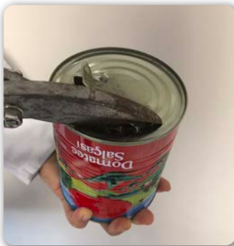
Görsel 2.29: Kutu kapağının teneke makası ile kesilmesi
