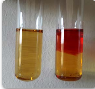
Görsel 8.23: Balda dekstrin tayininde oluşan renkler
