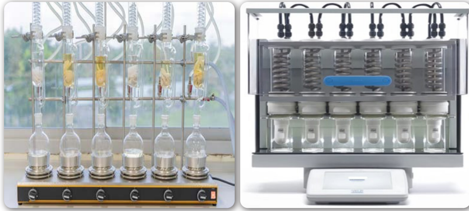
Görsel 7.14: Soxhlet ekstraksiyon düzeneği ve otomatik ekstraksiyon cihazı
