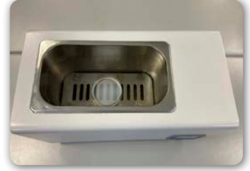
Görsel 6.10: Süt numunesinde ön kurutma işlemi
