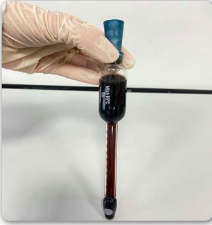
Görsel 6.15: Sıvıların karıştırılması ve sütteki proteinin parçalanması
