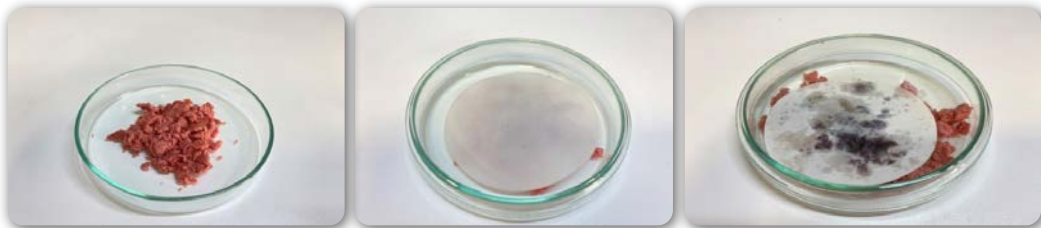
Görsel 7.19: Kurşun asetat ile hidrojen sülfür testi
