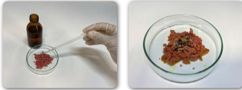
Görsel 7.18: Nessler çözeltisi ile amonyak testi
