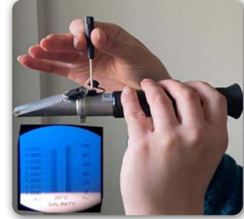
Görsel 1.12: El refraktometresinin kalibrasyonu
