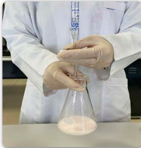
Görsel 6.13: Titrasyon yöntemi ile asitlik tayini
