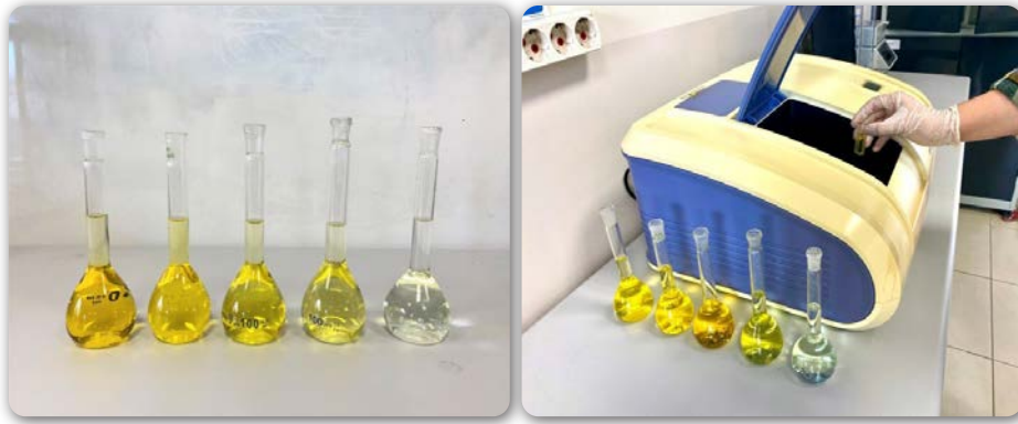
Görsel 7.24: Çözelti serisi ve spektrofotometrede okuma
