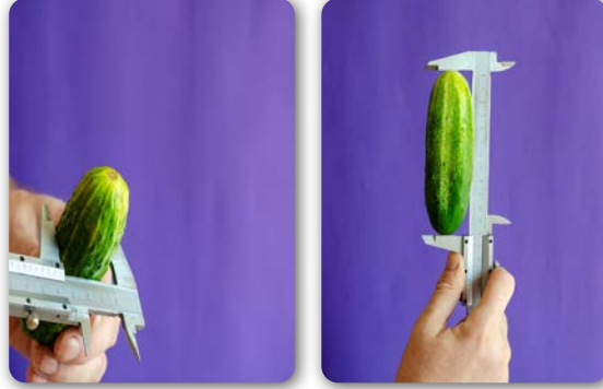
Görsel 1.2: Meyve eninin ve boyunun kumpas ile ölçümü
