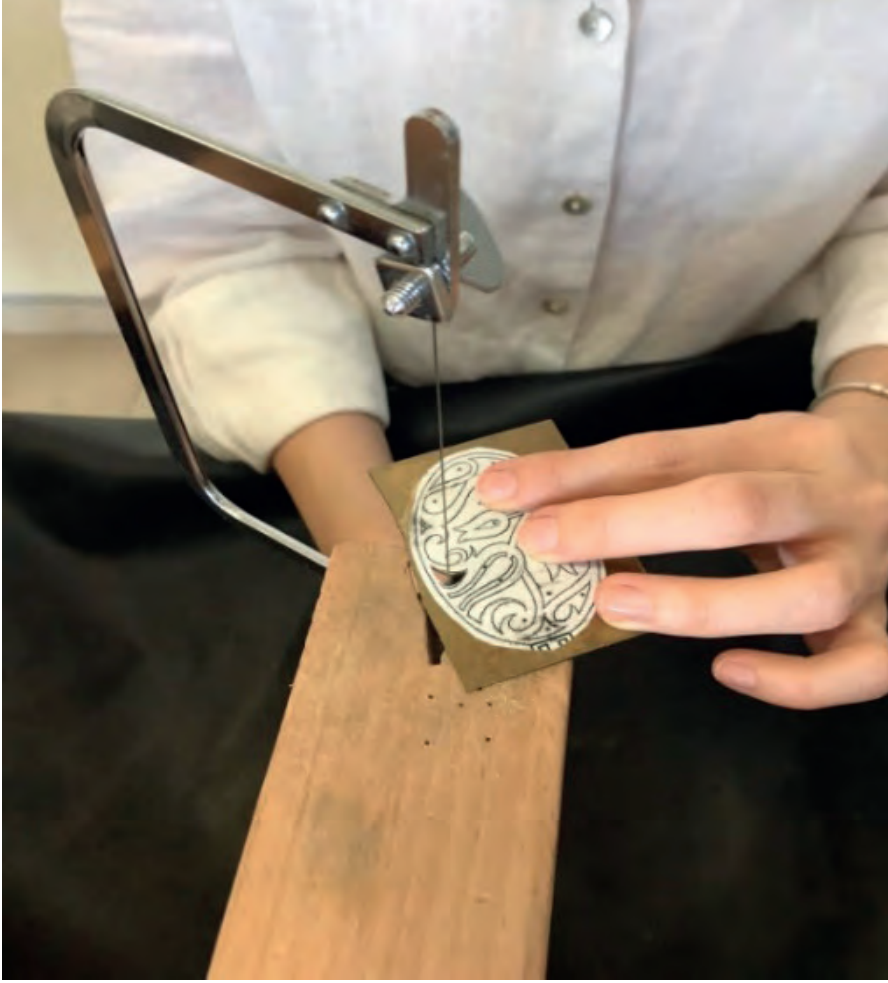
Görsel 5.19: Kıl testerenin dik tutuluşu ve parçanın sabitlenmesi
