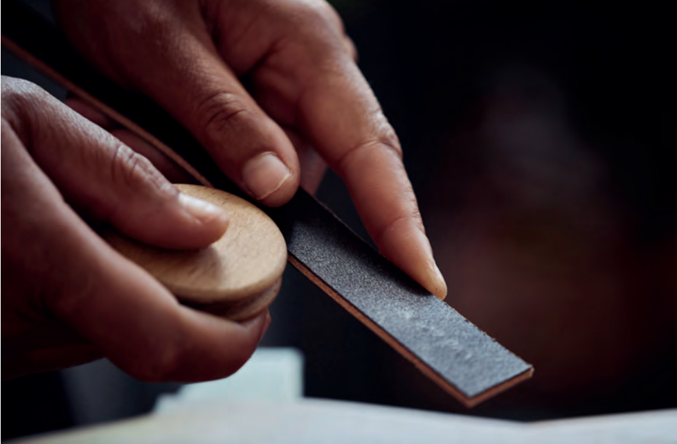
Görsel 6.9: Ahşap çubuğa sarılan zımparayla zımparalama
