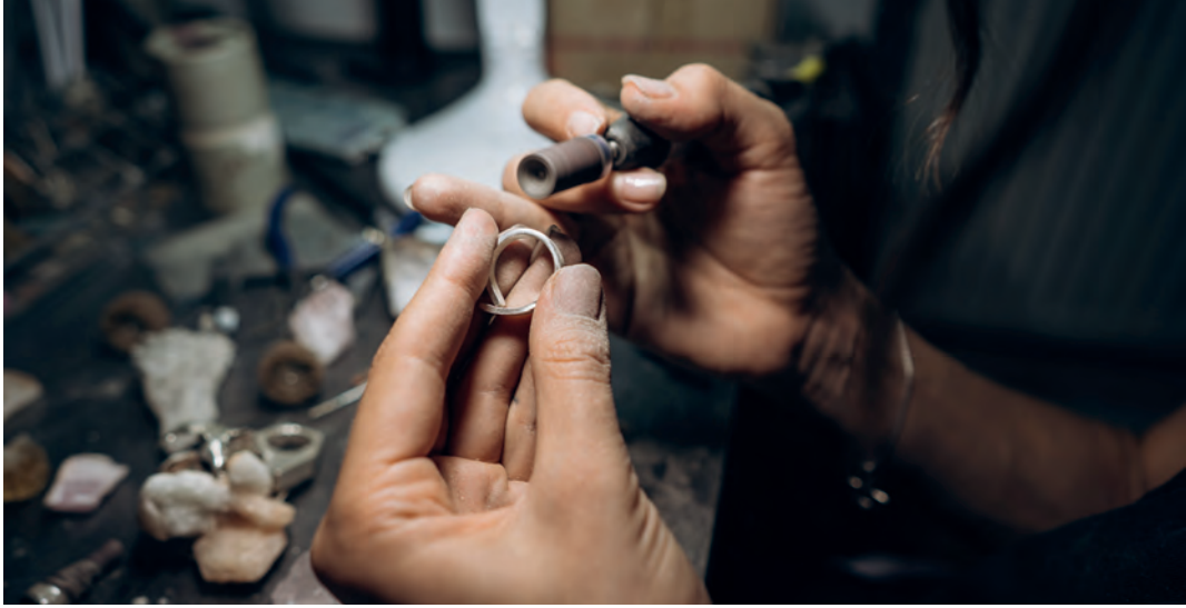
Görsel 6.10: Freze motoruyla zımparalama
