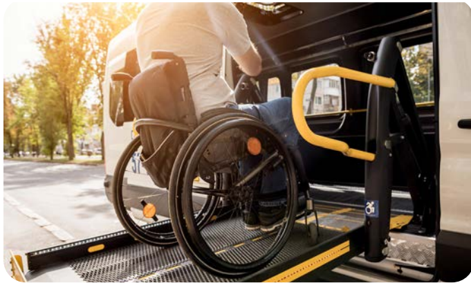
Görsel 4.6: Transfer aracı engelli rampası
