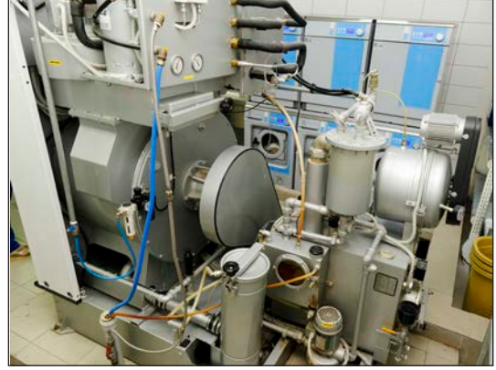
Görsel 4.6: Kuru temizleme makinesinin mekanik bölümü
