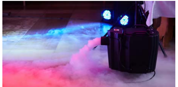
Görsel 3.28: Kuru buz ile çalışan sis makinesi
