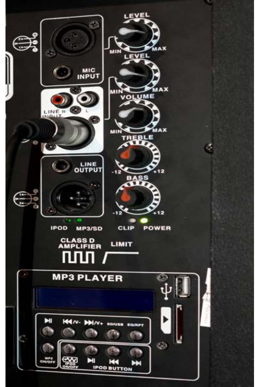
Görsel 3.12: Üzerinde müzik çalar, yükselteç ve yönetim aygıtı bulunan aktif hoparlör
