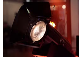
Görsel 3.20: Ayarlanabilir lamba kanatçığı olan fresnel mercekle lamba
