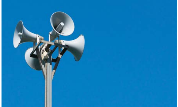
Görsel 3.37: Dış alan kullanımı için üretilmiş hoparlör
