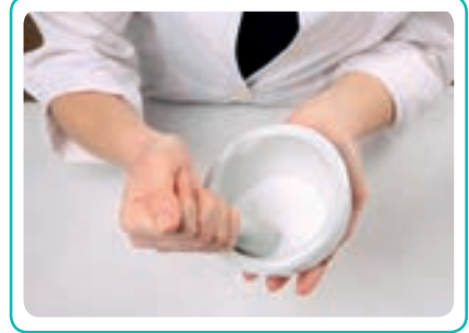
Görsel 2.1: Havanda öğütme ve karıştırma
