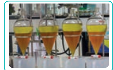
Görsel 3.3: Zeytinyağının ayırma hunisinde yıklanması
