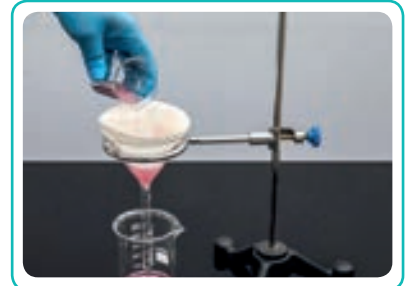
Görsel 3.8: Filtre kâğıdı ile yapılan filtrasyon
