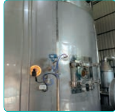
Görsel 6.2: Püskürtmeli kurutucu
