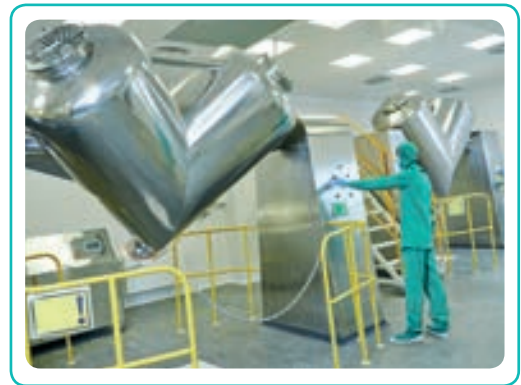
Görsel 2.2: V tipi endüstriyel karıştırıcı
