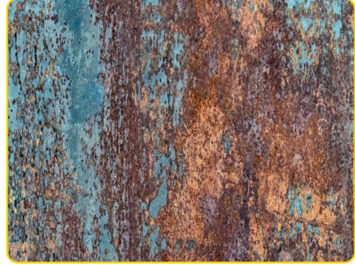
Görsel 1.19: Atmosferik korozyonun metale etkisi
