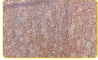
Görsel 1.4: Çeliğin üniform korozyonu
