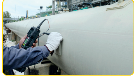
Görsel 1.12: Ultrasonik dedektörle boru kalınlığı ölçme
