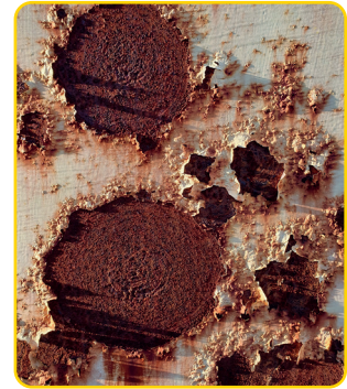
Görsel 1.6: Metal yüzeyinde oluşan çukur korozyon
