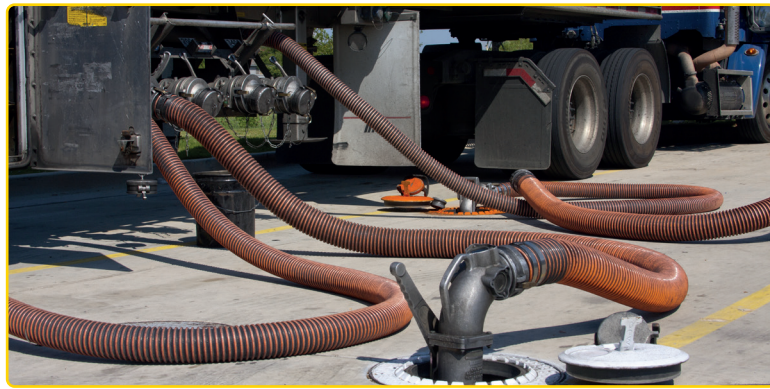
Görsel 2.1: Yakıt tankerinden yeraltı tankına yakıt pompalanması
