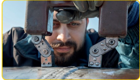
Görsel 1.14: Manyetik partikül incelemesi
