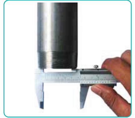
Görsel 1.13: Boru iç çap ölçümü
