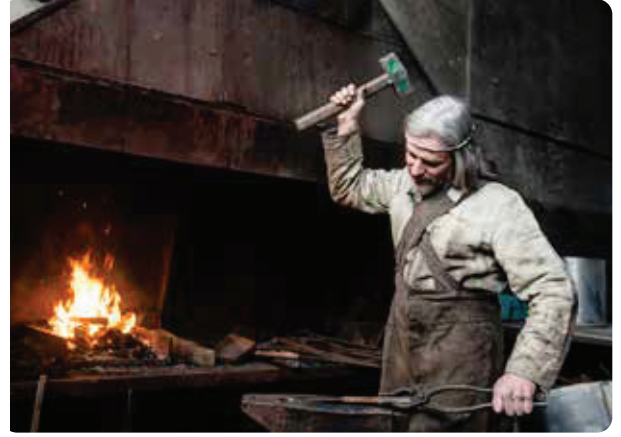
Görsel 5.1: Sıcak demirin maşa ile tutulması
