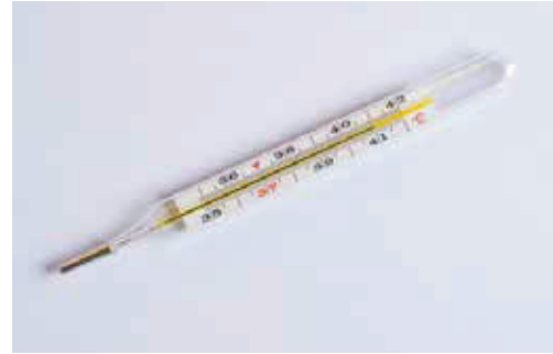
Görsel 3.2: Sıvı genişlemeli cam muhafazalı termometre
