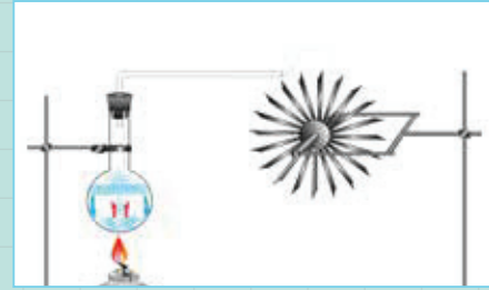
Görsel 9.10: Buharla su çarkını döndürme
