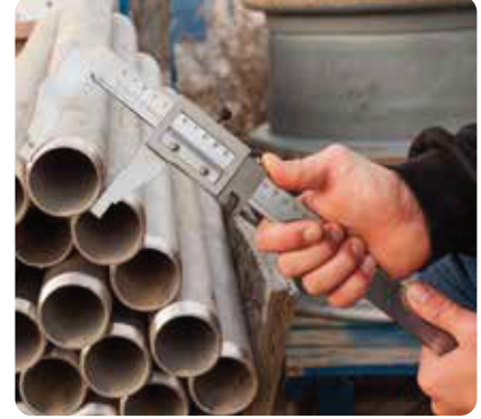
Görsel 1.12: Boru dış çap ölçümü
