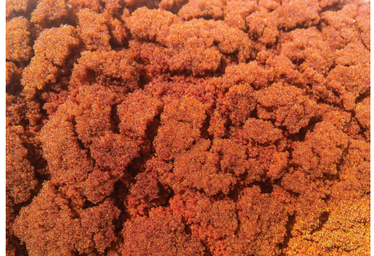
Görsel 8.2: Kolonlarda kullanılan reçine
