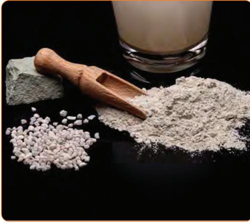
Görsel 15.6: Zeolit katalizörü (Ham taş, çakıl, toz ve süspansiyon hâli)
