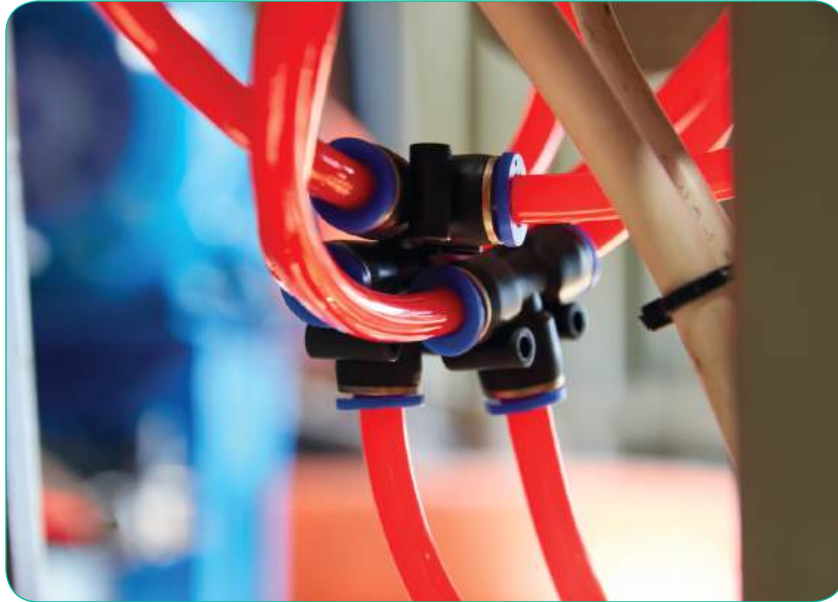
Görsel 4.3: Te bağlantı ile bağlanmış pnömatik hortumlar
