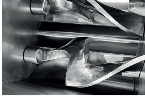
Görsel 1.19: Rotorlu karıştırma haznesi
