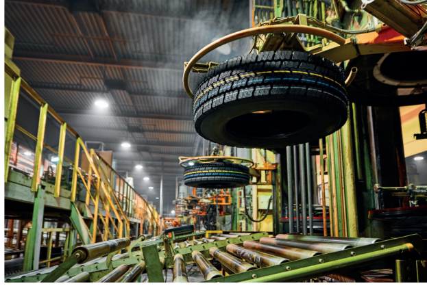
Görsel 5.16: Üniformita makinesinde lastik kontrolü
