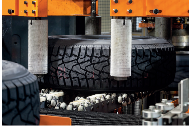
Görsel 5.3: Tıraşlama makinesinde lastik tıraşlama
