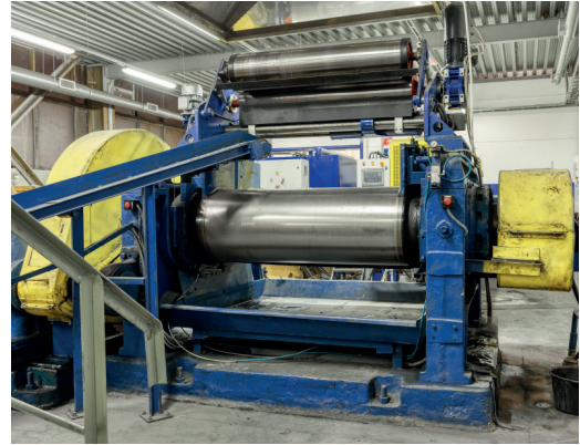
Görsel 1.15: Açık mikserin yere bağlantısı
