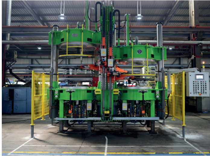
Görsel 4.13: Kayar sütun tipi hidrolik presli lastik pişirme makinesi
