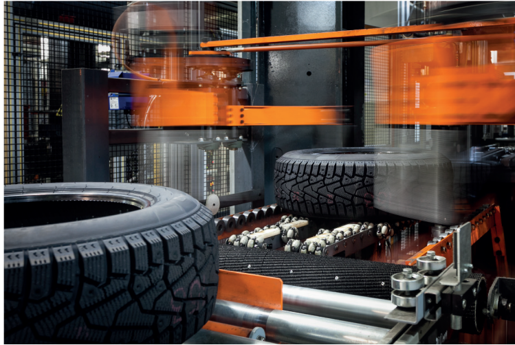
Görsel 5.4: Tıraşlama makinesinde lastik kontrolü
