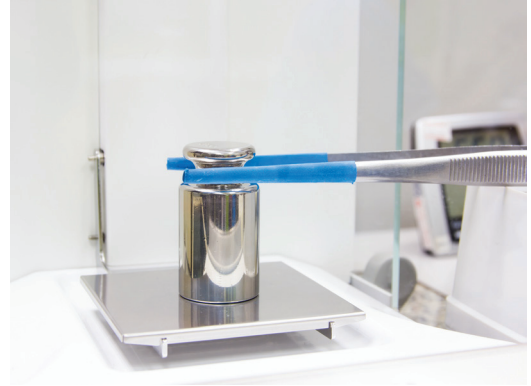
Görsel 1.1.3: Analitik terazinin kalibrasyon doğrulaması.
