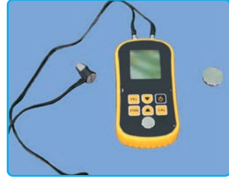
Görsel 3.19: Ultrasonik kalınlık ölçüm cihazı
