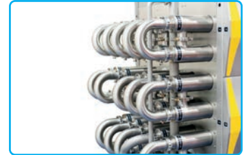
Görsel 2.20: Atık ısı kazanında kullanılan ısı değiştirici
