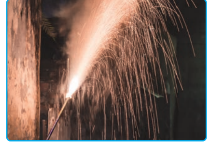
Görsel 4.27: Sıcak püskürtme yöntemi
