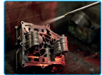
Görsel 4.5: Kum püskürtme yöntemi
