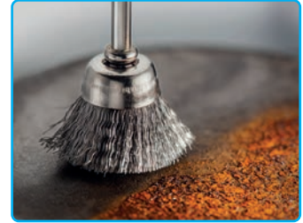
Görsel 4.4: Tel fırça ile temizlenen metal yüzey
