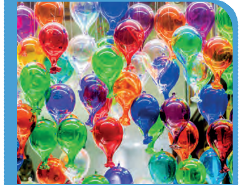
Görsel 3.9: İçerdiği metal oksitleri ile renklendirilmiş camlar
