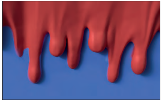
Görsel 3.1: Dikey yüzeyde meydana gelen akma ve sarkma kusuru
