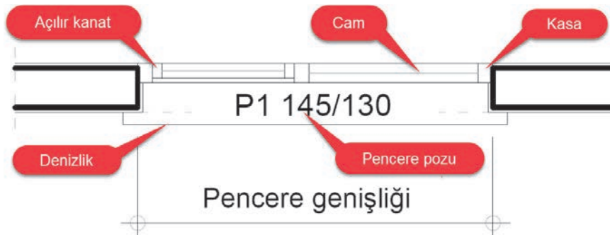
Şekil 5.38: Planda pencere çizimi
