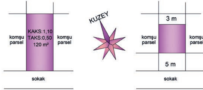
Şekil 1.47: İmar durum belgesine göre hazırlanmış parsel planı
