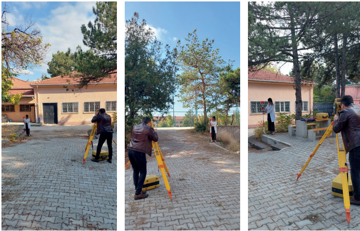
Görsel 3.53 a,b,c: Parke taşı kaplanmış alanın total station ile ölçülmesi
