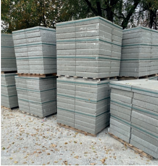
Görsel 4.9: Parke taşlarının stoklanması
