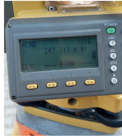
Görsel 3.54: Ölçülen alanın aletin ekranında görülmesi
