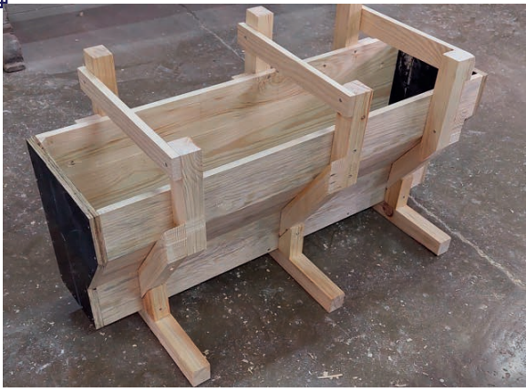
Görsel 3.16: Kalıp kanatlarının birleştirilmiş hâli
