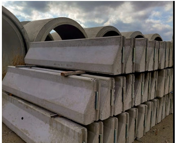
Görsel 3.21.e: Beton bariyer depolama
