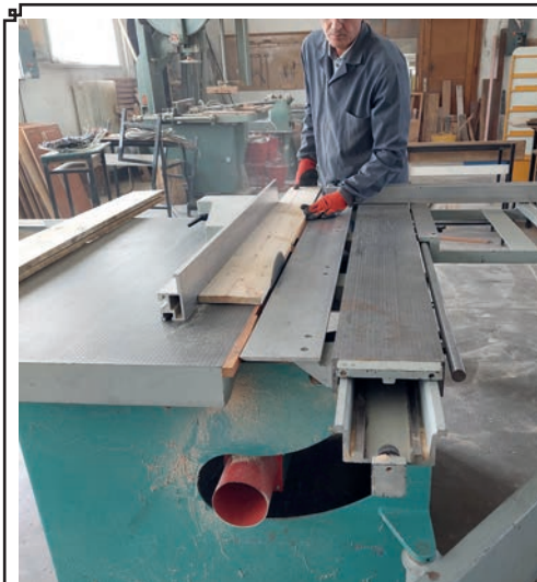
Görsel 1.19.a: Kalıp tahtalarını enine ebatlama
