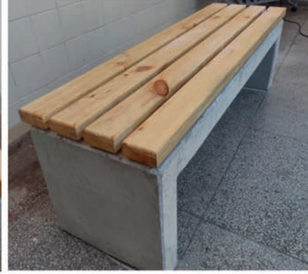
Görsel 1.50.c: Beton bankın ahşap latalarla kaplanmış hâli
