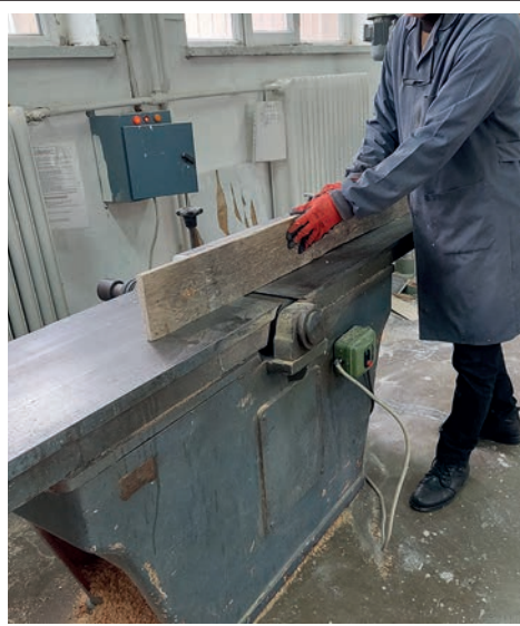
Görsel 1.18: Kalıp tahtalarına cumba yapılması
