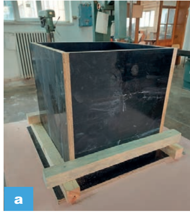
Görsel 2.12.a-b: Saksı kalıbı kuşaklarının bağlanması
