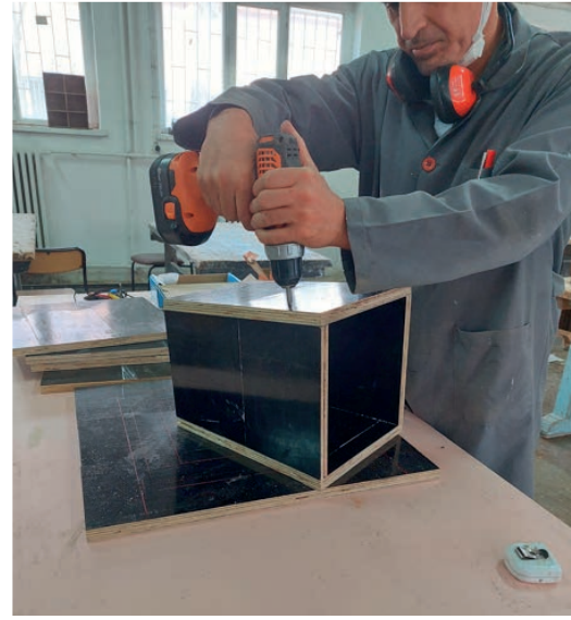
Görsel 2.10: Kalıp parçalarının vida ile birleştirilmesi
