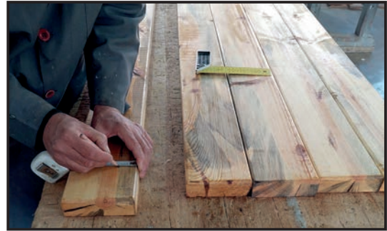
Görsel 1.51: Ahşap lataların markalanması
