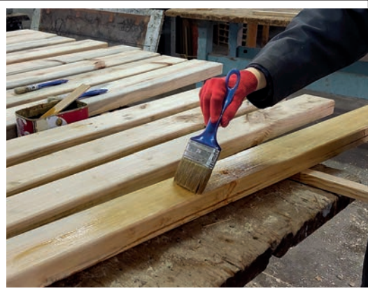
Görsel 1.45: Ahşap lataların fırça ile empenye edilmesi
