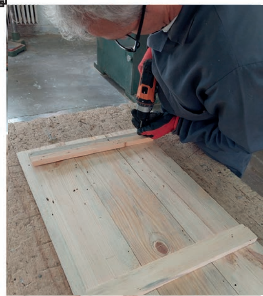
Görsel 1.21.a: Klapelelerin bağlanması
