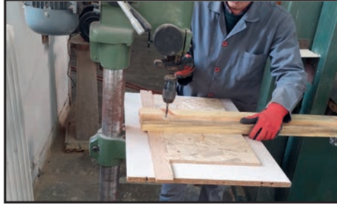
Görsel 1.52: Lataların markalanan yerlerden delinmesi
