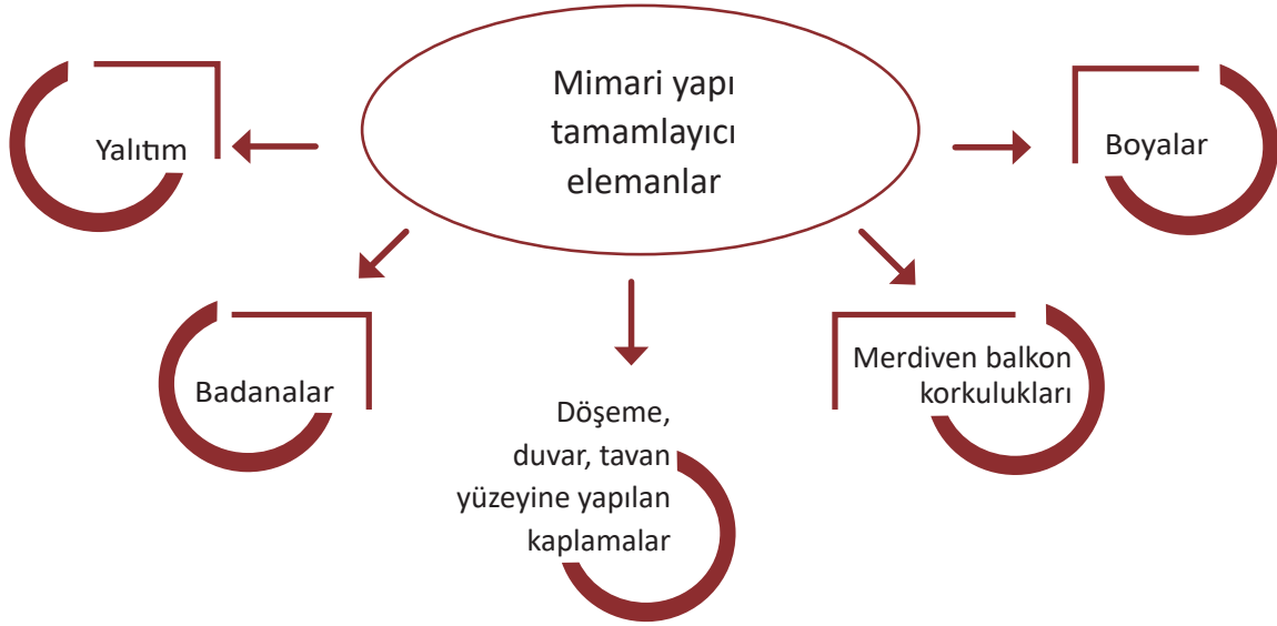
Şema 2.10: Mimari yapı tamamlayıcı elemanlar
