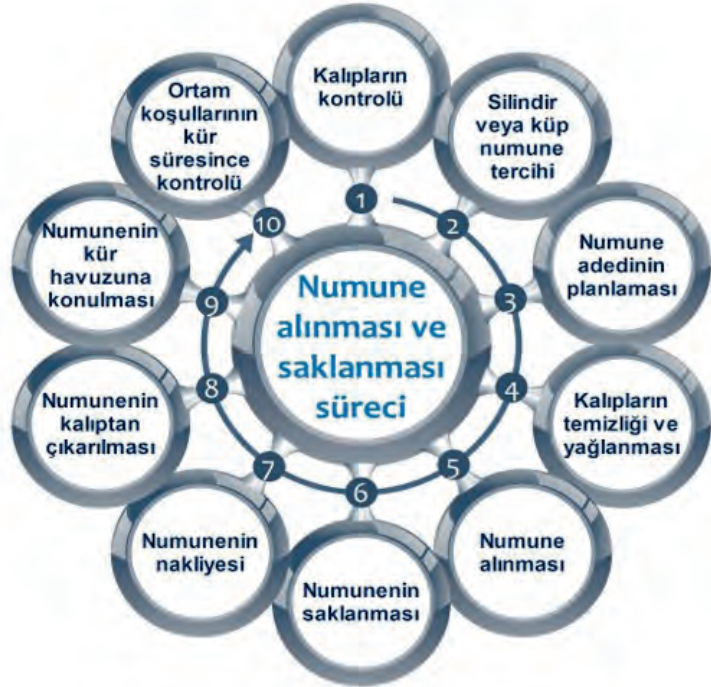
Şema 4.2: Taze beton numune alma ve saklama süreci
