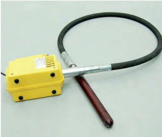
Görsel 2.20: Daldırma (İç) vibratörler
