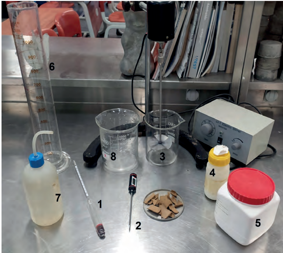
Görsel 11.4: Hidrometre deney seti
