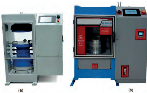
Görsel 6.8: Beton basınç dayanım test cihazı
