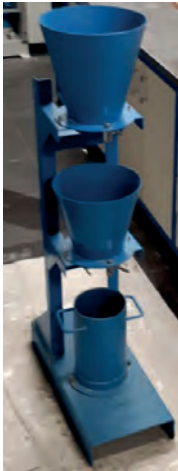
Görsel 5.3: Sıkıştırma faktörü deney aparatı
