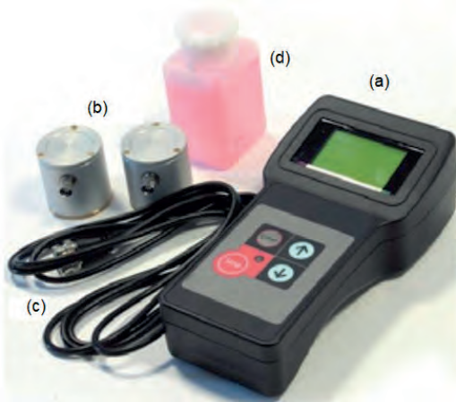
a) Ultra ses dalga hızı test cihazı b) İletici ve alıcı transdüser c) Veri bağlantı kablosu d) Bağlayıcı sıvısı
