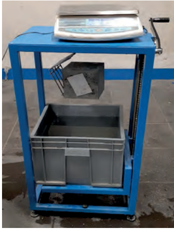
Görsel 7.2: Özgül ağırlık sehpası deney düzeneği
