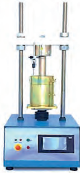
Görsel 12.3: Otomatik CBR deney cihazı
