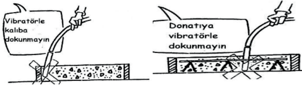
Görsel 2.28: Vibratör ucunun kalıba ve donatıya temas etmesi
