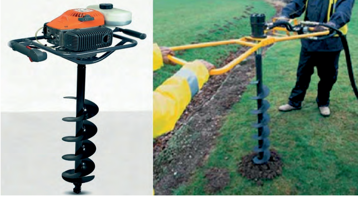
Görse 8.20: Mekanik burgu yöntemiyle örselenmiş numune alma
