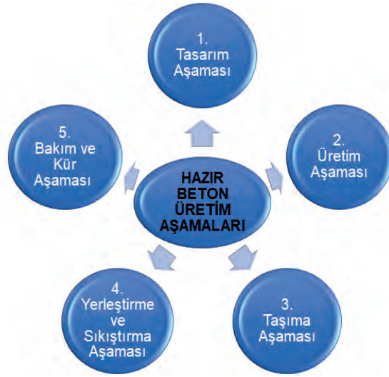
Görsel 3.1: Hazır beton üretim aşamaları
