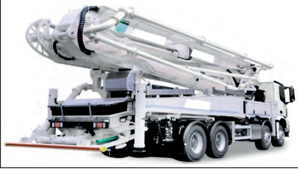
Görsel 3.4: Beton pompası
