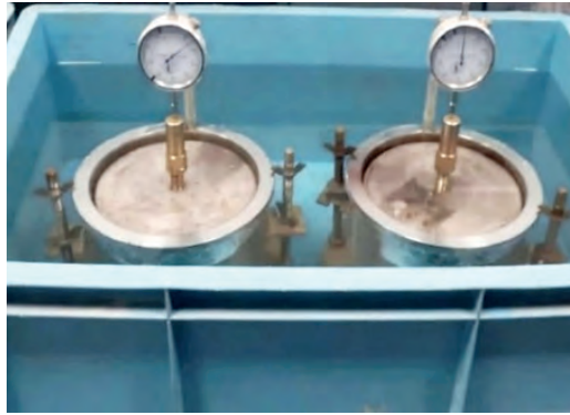
Görsel 12.5: Numunelerin suda bekletilmesi
