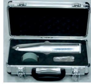
Görsel 7.9: Beton test çekici
