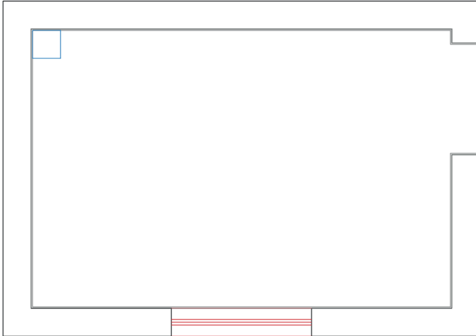
Görsel 10.7: İlk seramik karonun yerleştirilmesi
