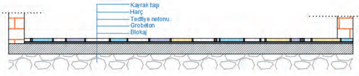
Görsel 10.42: Zemine kayrak taşı kaplama kesiti
