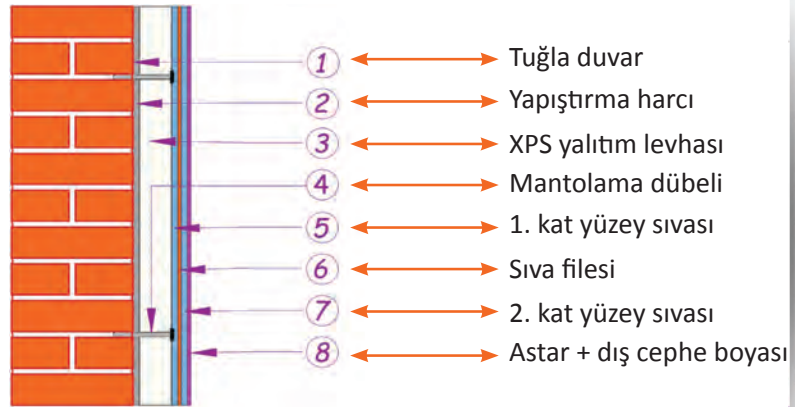
Şekil 2.5: Yalıtım detay çizimi açıklayıcı bilgilerin yazılması
