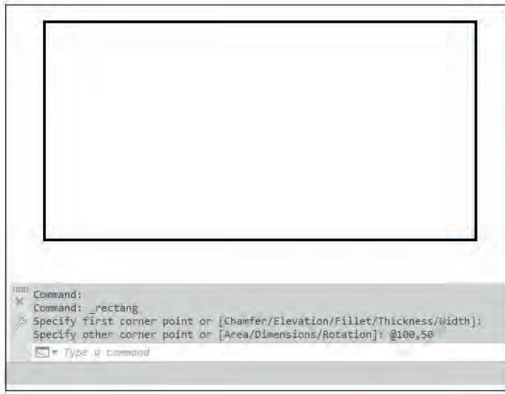
Çizim 1.3: Dörtgen (rectangle) komutunun kullanımı
