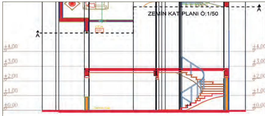
Şekil 6.33: 1. kat planından kesit çizgisine göre taşıma
