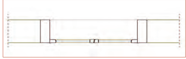
Şekil 7.72: Pencerenin plan kısmının çizimi
