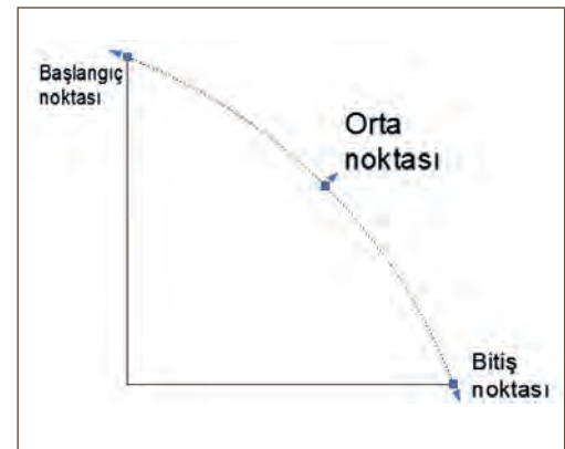
Şekil 1.19: Arc (Yay çizgi) komutu
