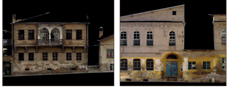
Resim 7.18: Lazer tarama (nokta bulut) yöntemi ile oluşturulmuş görünüşler
