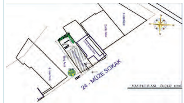
Şekil 8.27: Yerleşim planından arsa sınırlarını kopyalama
