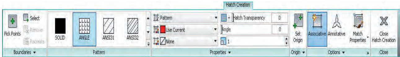
Resim 5.19: Hatch tarama düzenleme ayarları
