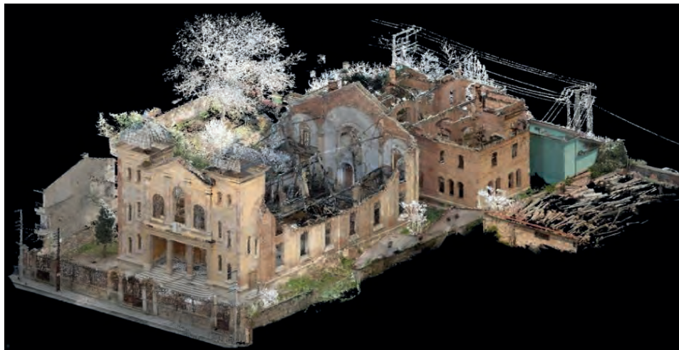
Şekil 6.65: Üç boyutlu lazer tarayıcılarla nokta bulutları
