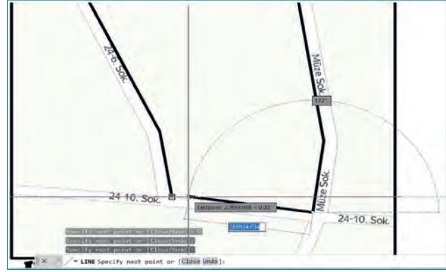
Şekil 8.3: Parsel sınırlarını çizme
