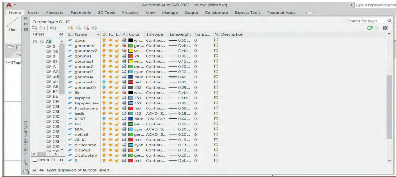
Şekil 6.20: Bilgisayarda katman oluşturma
