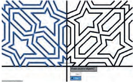
Şekil 4.67: Tek karonun MIRROR komutu ile simetrisinin alınışı
