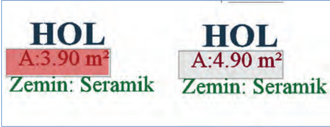
Resim 5.18: DDEDIT yazı düzenleme uygulaması
