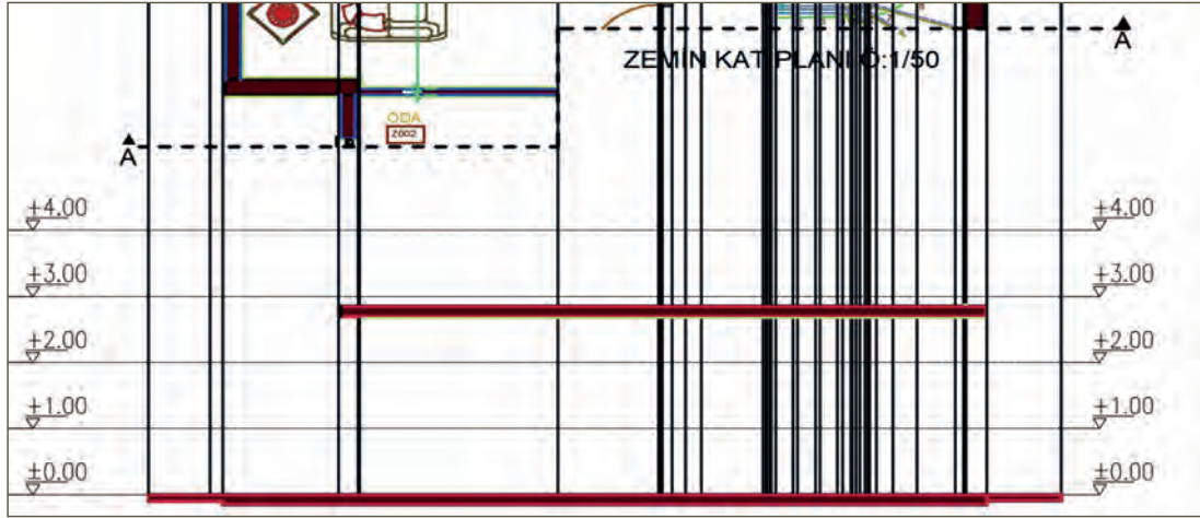
Şekil 6.29: Zemin kat yüksekliğine göre tavan döşeme çizimi
