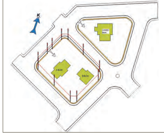
Şekil 6.58: Jalonlarla ölçüm alanının belirlenmesi
