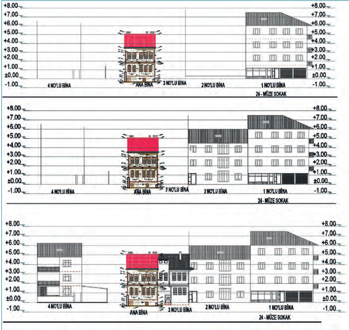
Şekil 8.45: 1, 2, 3 ve 4 no.lu binaların görünüşlerinin sokaktaki yerine taşınması/çizimi
