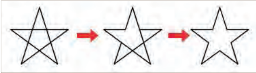
Şekil 1.28: Trim komutu ile düzenlenmiş şekil
