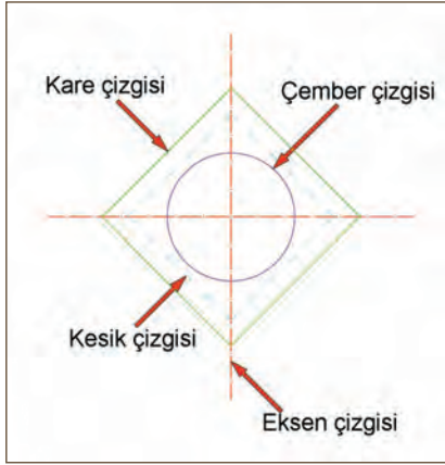
Şekil 1.13: Oluşturulan katmanlara göre yapılan çizim
