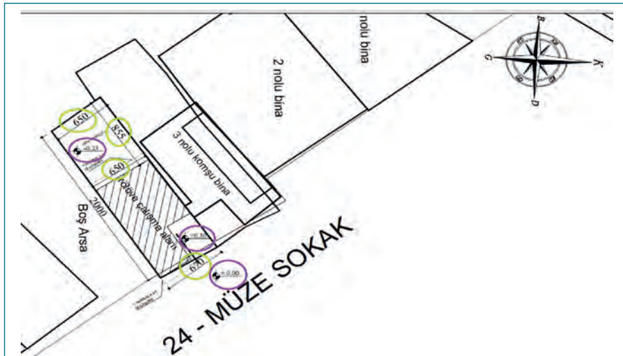
Şekil 8.11: Yerleşim planı yatay ve düşey ölçüldürmenin yapılması
