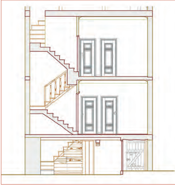
Şekil 7.42: Kesitte kapı çizimi
