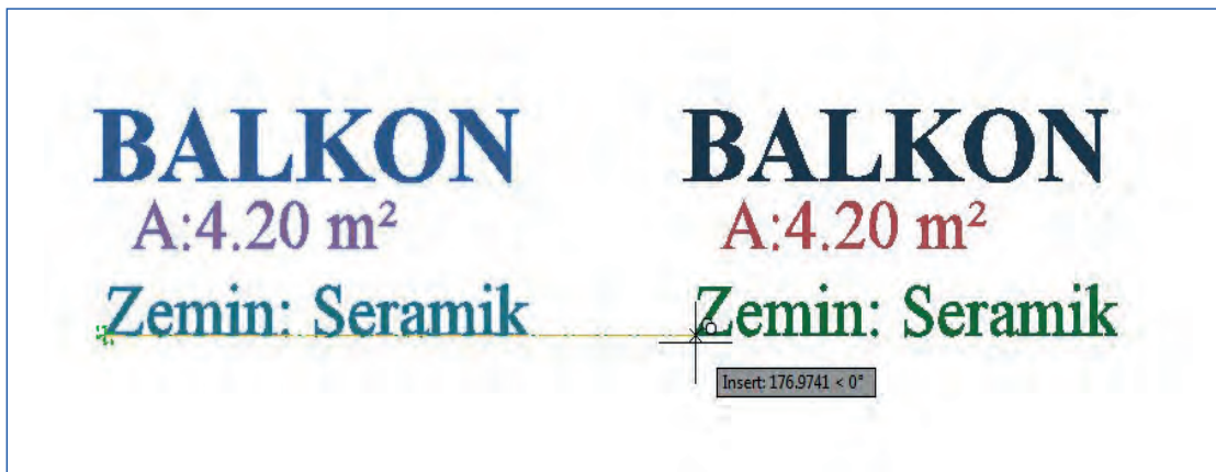
Resim 5.17: Copy komutuyla yazı kopyalama uygulaması
