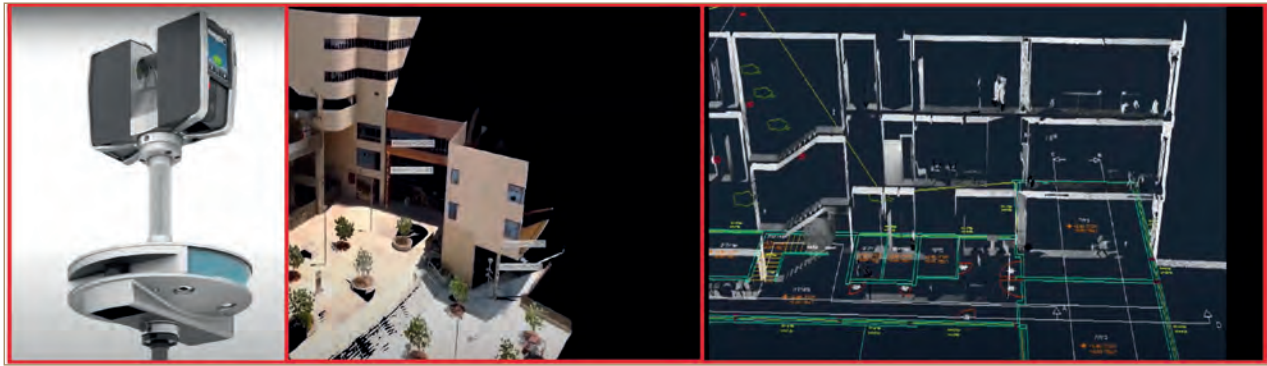
Şekil 6.13: Üç boyutlu lazer tarayıcı ve tarayıcının elde ettiği görüntüler
