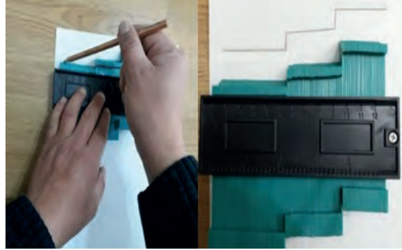
Resim 6.13: Profil tarağıyla çizim yapma
