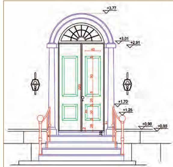
Şekil 3.56: Dış merdiven ön görünüş
