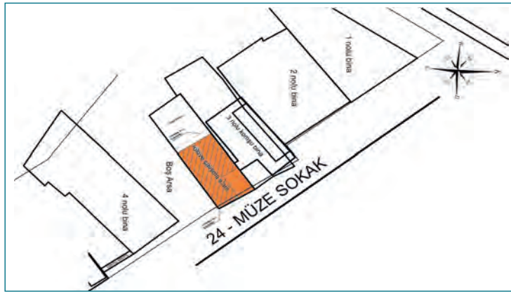
Şekil 8.10: İmar durumunun yerleşim planına işlenmesi
