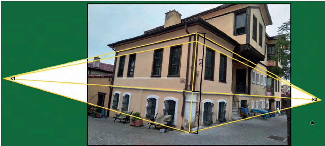
Şekil 8.36: İki kaçma noktalı perspektif resimden ölçü alma
