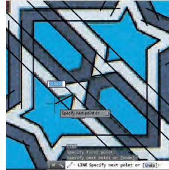
Şekil 4.64: Fazla çizgilerin TRİM ile budanması
