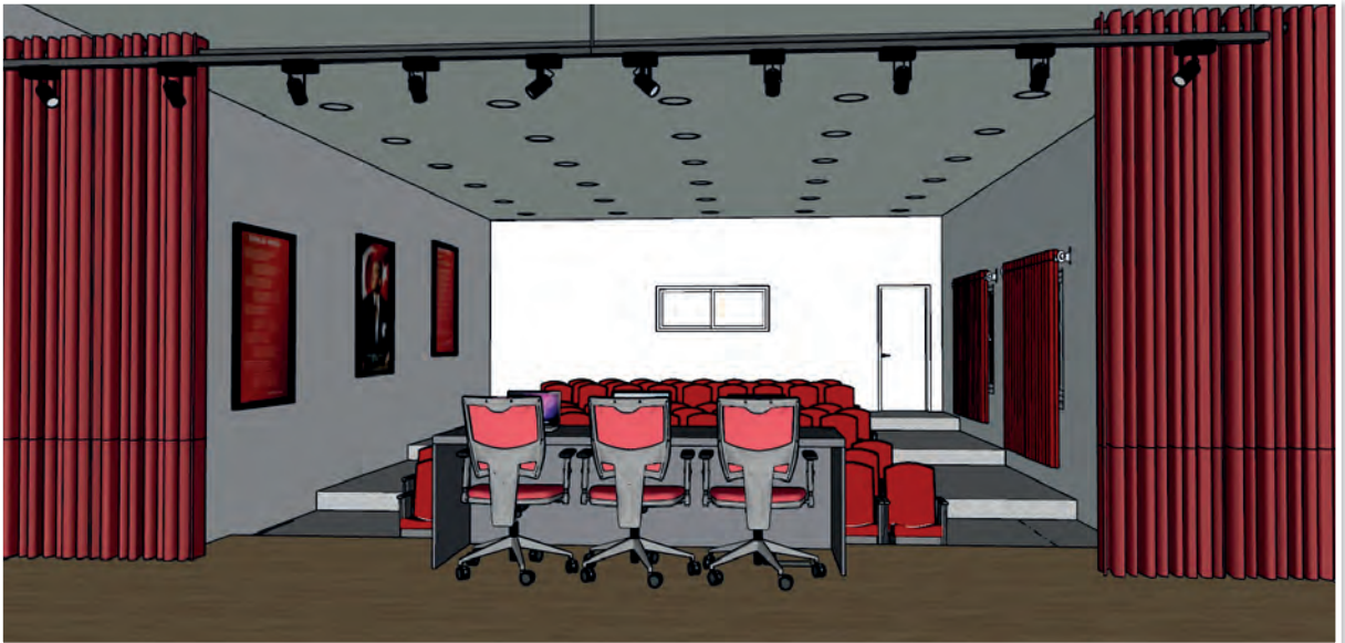
Görsel 3.48: Konferans salonu tavan spot ışıklarının modellenmesi ve yerine yerleştirilmesi
