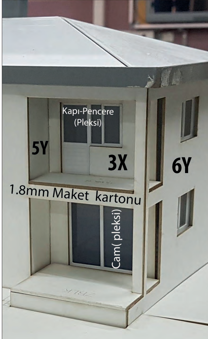
Görsel 3.6: Maket geçici birleştirme prova örneği
