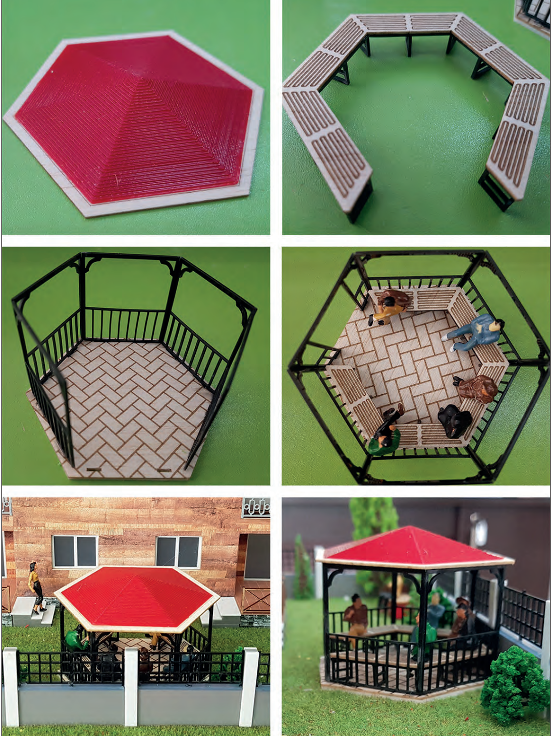
Görsel 5.24: Çardak imalatı ve parçaların yapıştırılması
