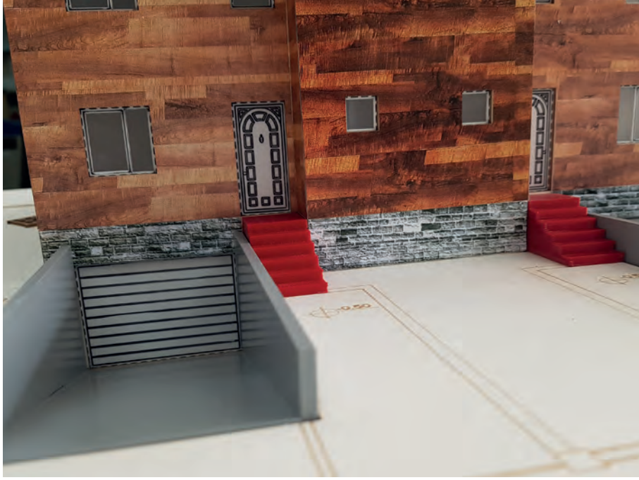
Görsel 5.7: Otopark rampası ve merdiven yerleşimi
