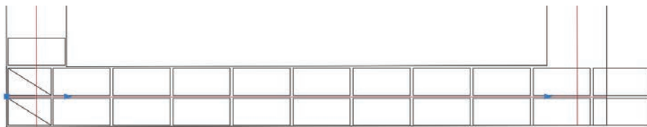
Görsel 1.30: Array komutu yardımı ile tuğla aralıklarının ve derzlerin ayarlanması
