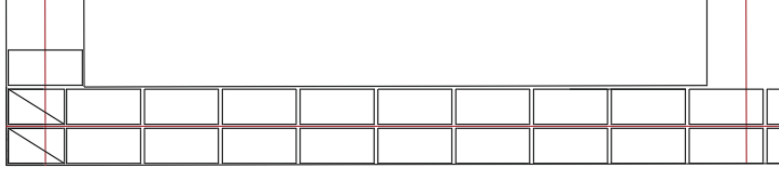
Görsel 1.31: Duvar dışına taşan çizimlerin temizlenmesi
