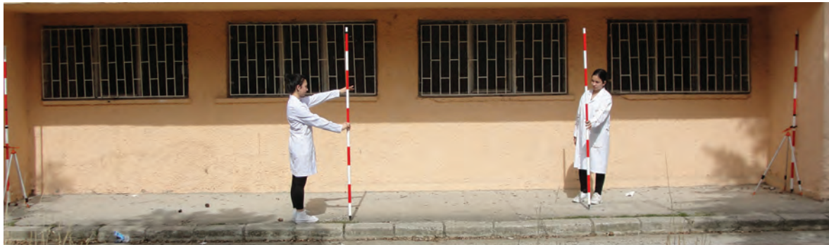
Görsel 3.11: Birbirini gören fakat arkasına geçilemeyen noktaları birleştiren AB doğrusunun uygulaması
