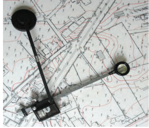
Görsel 7.19: Mekanik planimetrenin kullanımı
