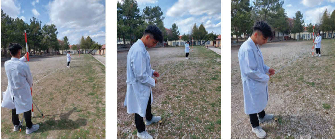
Görsel 4.3: Düz arazide yatay uzunluk ölçümü uygulaması
