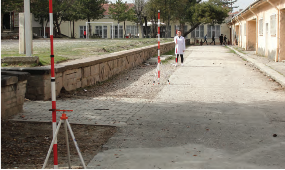
Görsel 3.8: Jalonlar yardımı ile AB doğrusu uzantısında nokta belirleme uygulaması
