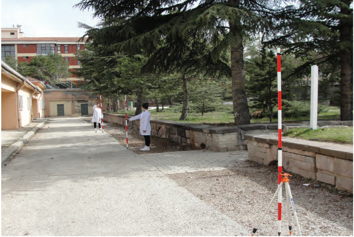
Görsel 3.6: Jalonlar yardımı ile AB doğrusu üzerinde nokta belirleme uygulaması
