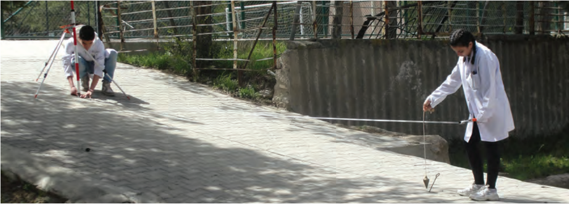
Görsel 4.5: a) Meyilli arazide uzunluk ölçümü başlangıcı
