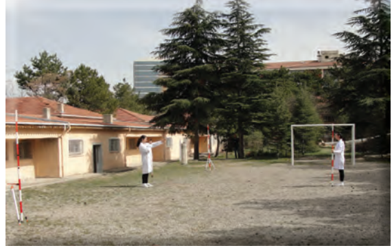
Görsel 1.18: Prizma ile doğru üzerindeki noktadan dik çıkma uygulaması
