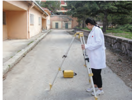
Görsel 5.35: Nivo sehpa'nın yaklaşık olarak eşkenar üçgen olacak şekilde yerleştirilmesi
