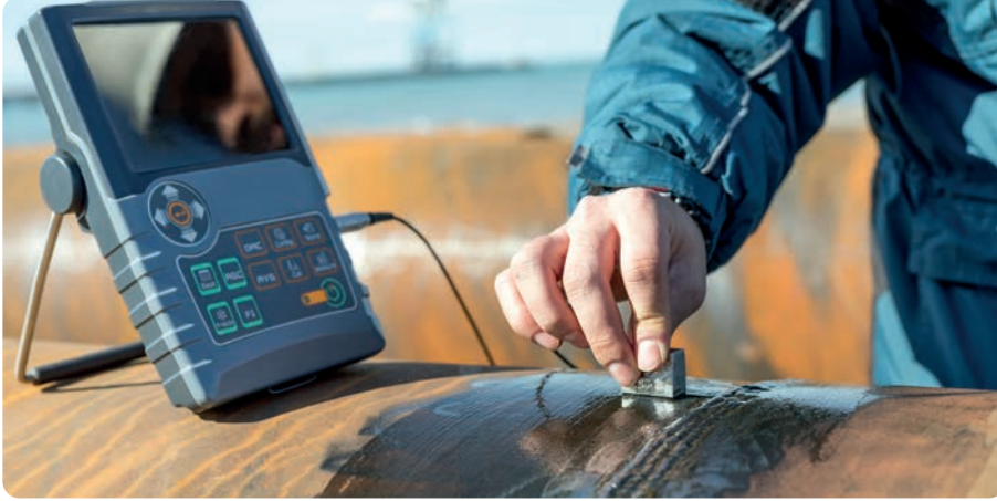
Görsel 5.11: Ultrasonik test uygulaması
