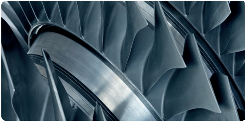
Görsel 2.4: Uçak motorunda titanyum malzemenin kullanımı
