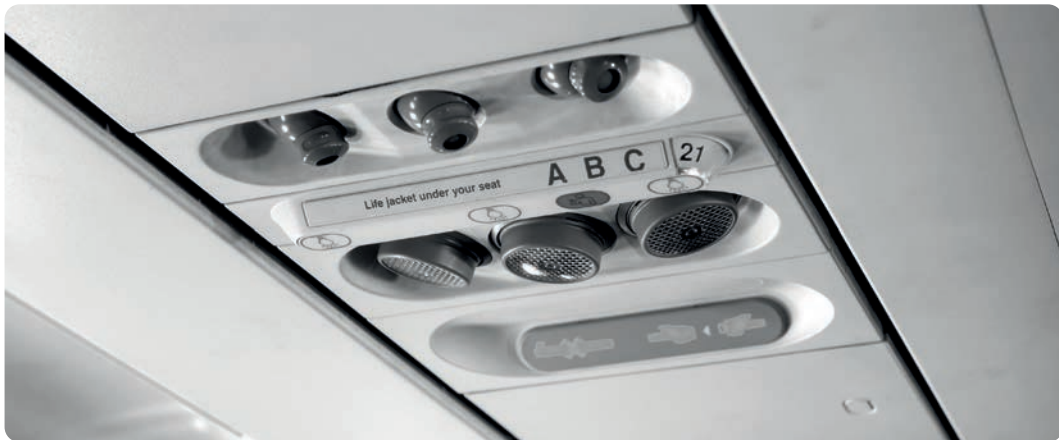
Görsel 2.8: Uçak havalandırmasında plastik kullanımı
