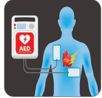
Görsel 3.31: OED'nin pedler aracılığıyla kalbe verdiği elektriksel şok
