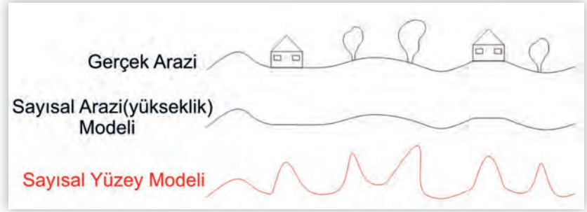
Görsel 3.21: Sayısal arazi ve sayısal yüzey modeli
