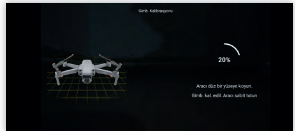
Görsel 2.25: Gımbal kalibrasyonu tamamlanması işlemi
