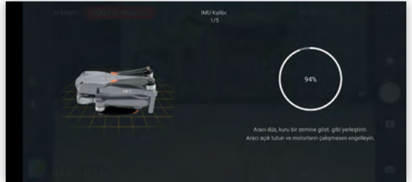
Görsel 2.22.a: IMU kalibrasyon ekranında tarif edilen duruş şekli
