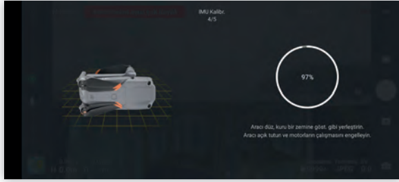
Görsel 2.22.d: İMU kalibrasyon ekranında tarif edilen duruş şekli
