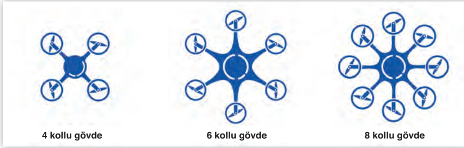
Görsel 1.18: Kol sayılarına göre drone gövdesi tipleri
