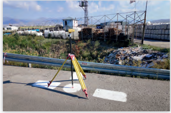
Görsel 2.8: Yer kontrol noktalarının işaretlenmesi
