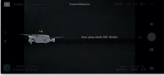
Görsel 2.20.a: Pusula kalibrasyon ekranında tarif edilen döndürme hareketi
