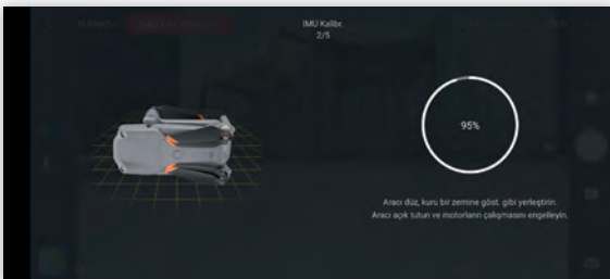
Görsel 2.22.b: IMU kalibrasyon ekranında tarif edilen duruş şekli
