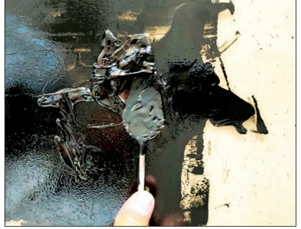
Görsel 2.61: Matbaa mürekkebi ve pastanın karıştırılması
