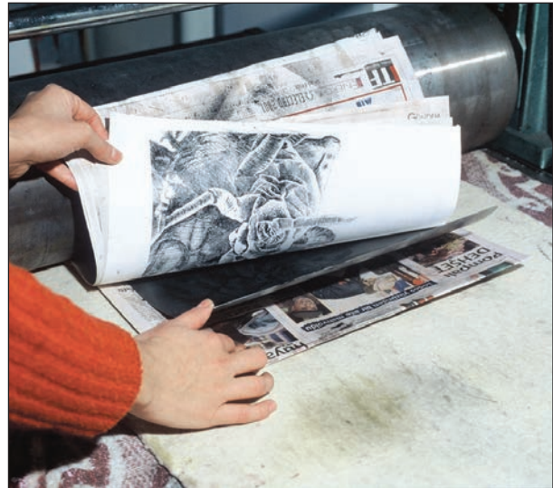
Görsel 3.32: Baskı pres makinası ile baskı yapma
