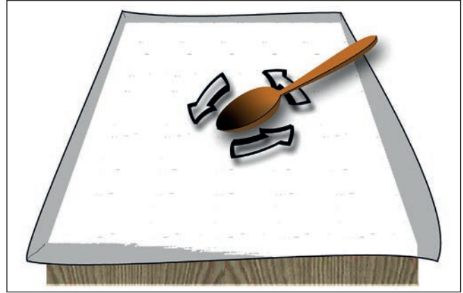
Görsel 2.64: Tahta kaşıkla sürterek mürekkebin kâğıda geçirilmesi
