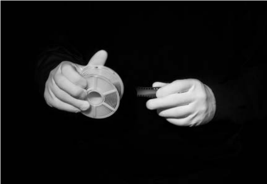
Görsel 4.13: Filmin spirale geçirilmesi
