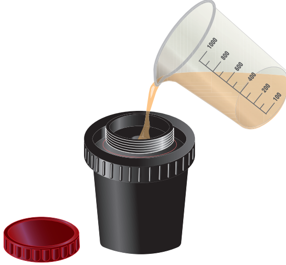
Görsel 4.18: Geliştiricinin tanka dökülmesi
