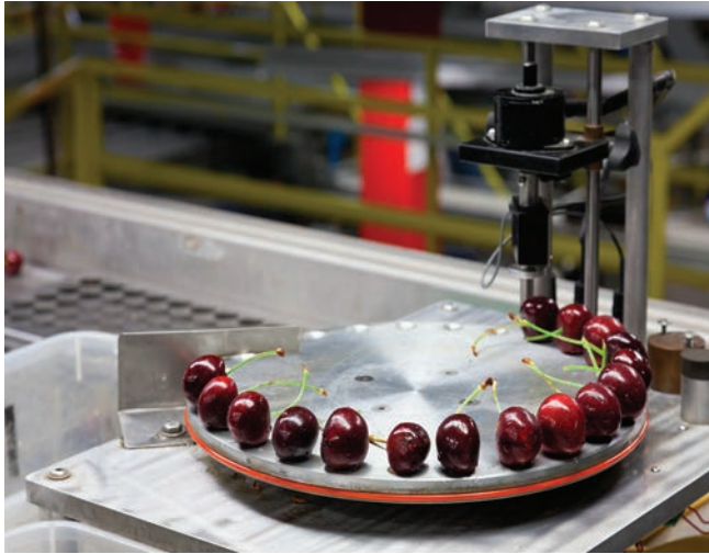
Görsel 1.9: Kiraza basınç uygulayarak sertlik ölçen bir alet
