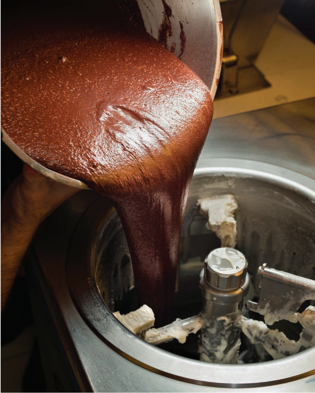
Görsel 2.33: Dondurma üretiminde kullanılan çarklı karıştırıcı
