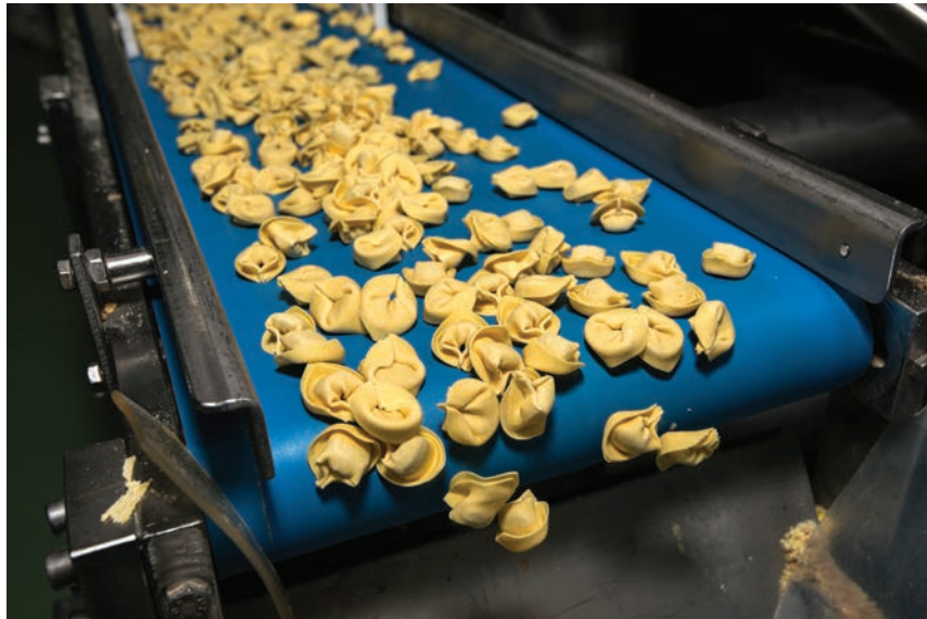
b) Unlu mamullerde kullanılan iletim hattı
