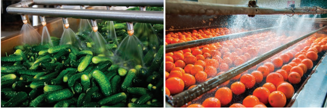
Görsel 1.19: Farklı ham madde gruplarında kullanılan püskürtme sistemleri
