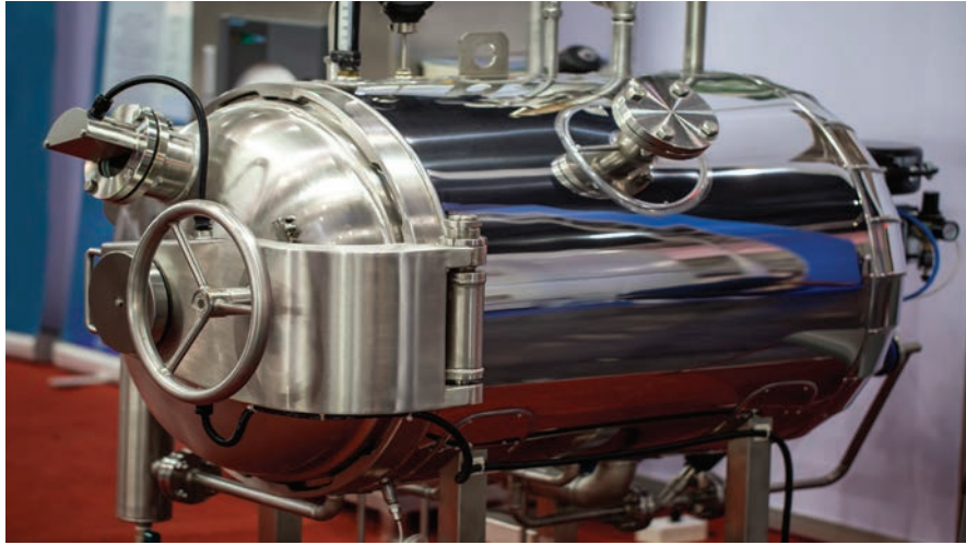
Görsel 2.35: Kesikli sistem çalışan bir sterilizatör
