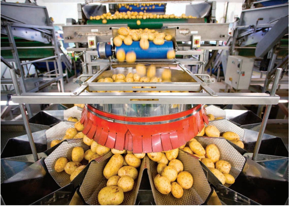
Görsel 1.20: Gıda işletmesinde patatesleri sınıflandırmada kullanılan bir makine
