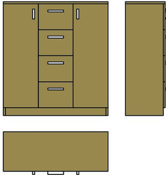
Görsel 10.21: Dolabın ön, üst ve yan görünüşleri
