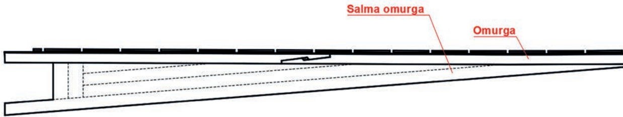
Görsel 1.4: İki ahşap malzemeyle birleştirilmiş omurga
