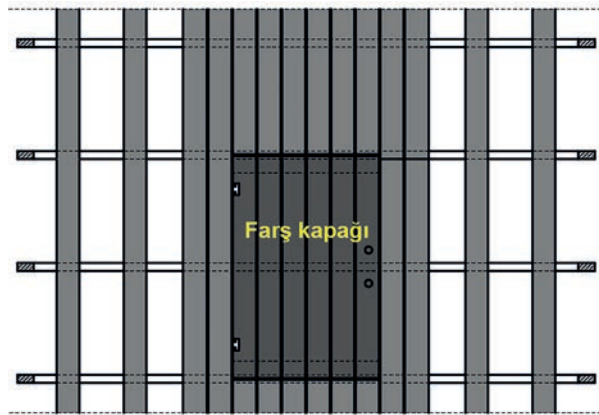
Görsel 3.10: Farş tahtası ve farş kapağının üç boyutlu gösterilmesi
