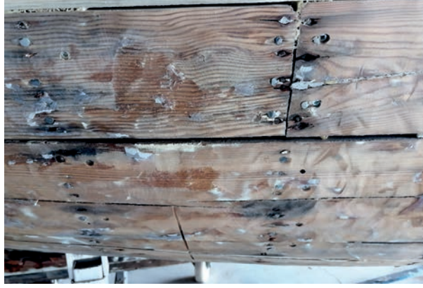
Görsel 1.9: Onarılacak dış kaplamanın açığa çıkarılması
