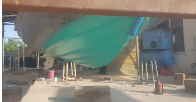
Görsel 6.5: Zehirli boya yapılması
