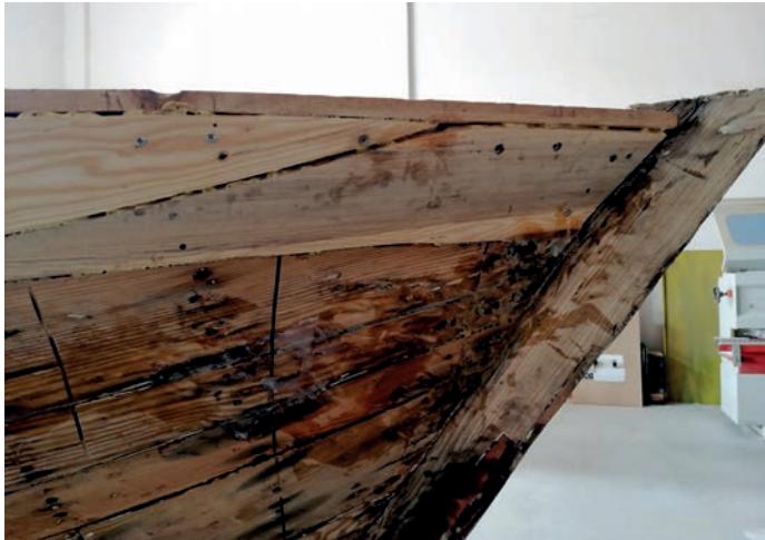
Görsel 1.12: Baş bodoslamasının açığa çıkarılması
