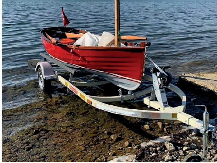
Görsel 1.1: Teknenin römork ile karaya çıkarılması
