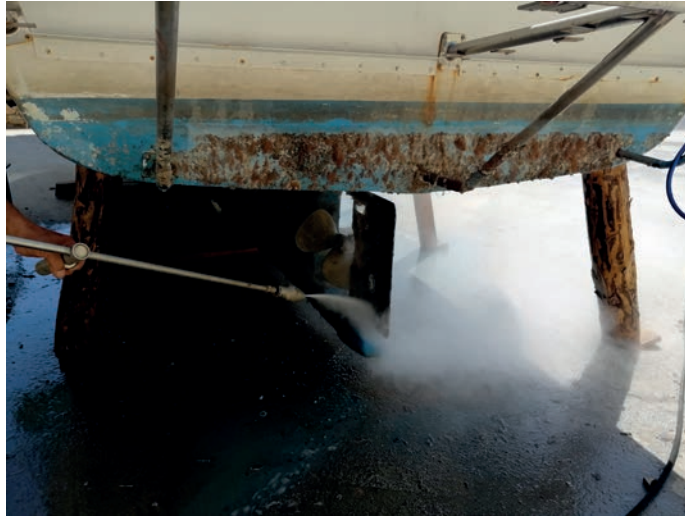
Görsel 2.3: Dümen palasının temizlenmesi
