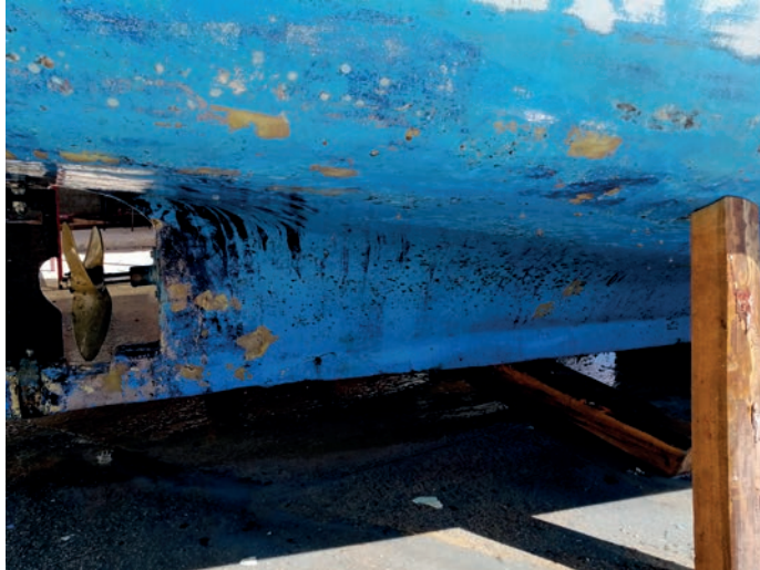
Görsel 2.7: Temizlenmiş dümen palası, pervane ve karina yüzeyi
