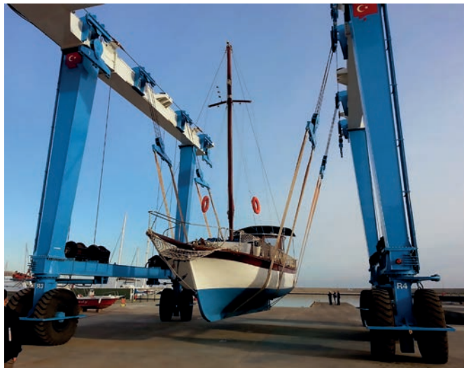
Görsel 1.2: Yatın tekerlekli lift ile karaya çıkarılması
