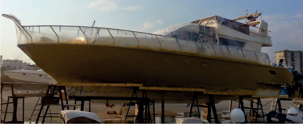
Görsel 5.3: Yat yüzeyinin astar boyaya hazırlanması
