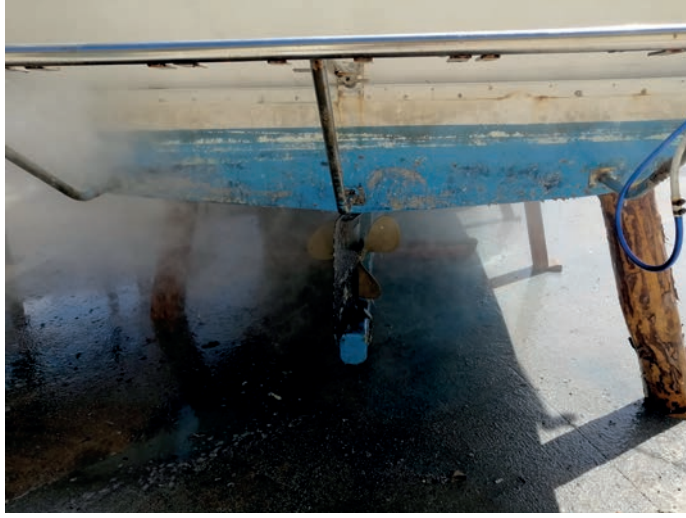
Görsel 2.5: Kıç aynanın temizlenmesi
