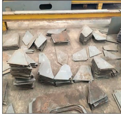
Görsel 1.11: CNC makinesinde kesilmiş sac parçalar
