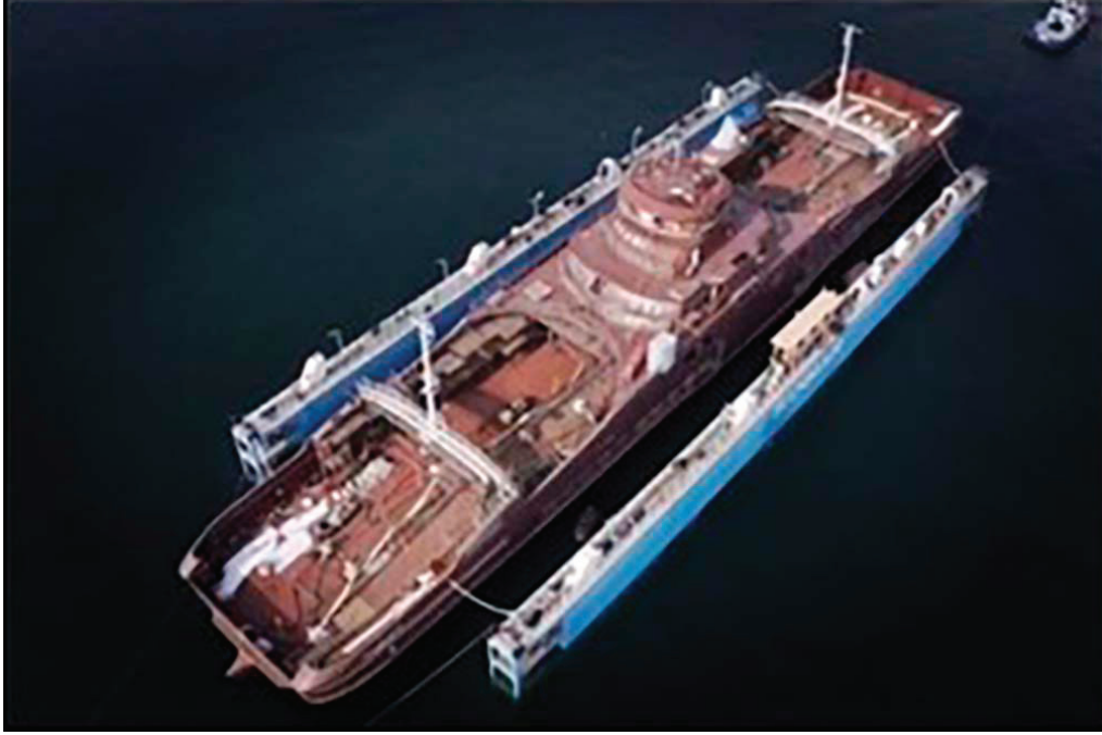
Görsel 1.33: Geminin havuzdan suya indirilmesi
