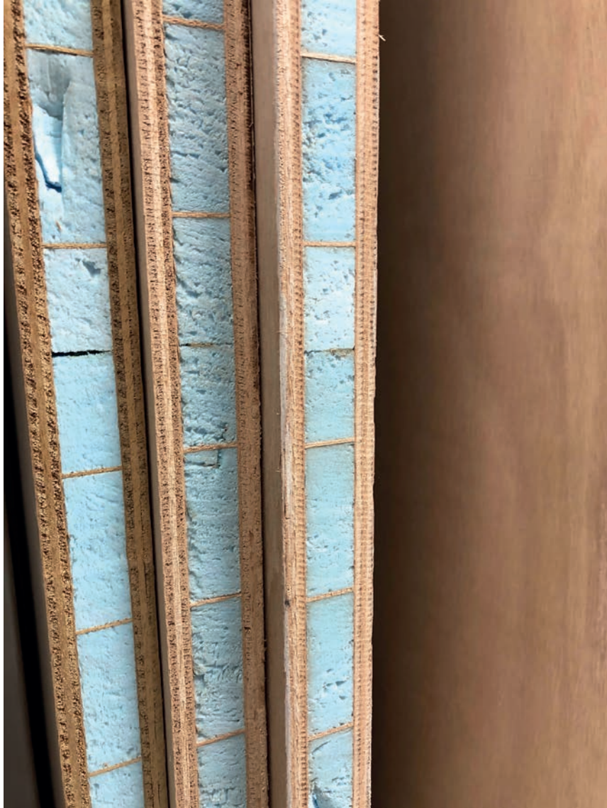
Görsel 5.27: Kontrplak ile imal edilmiş sandviç panel
