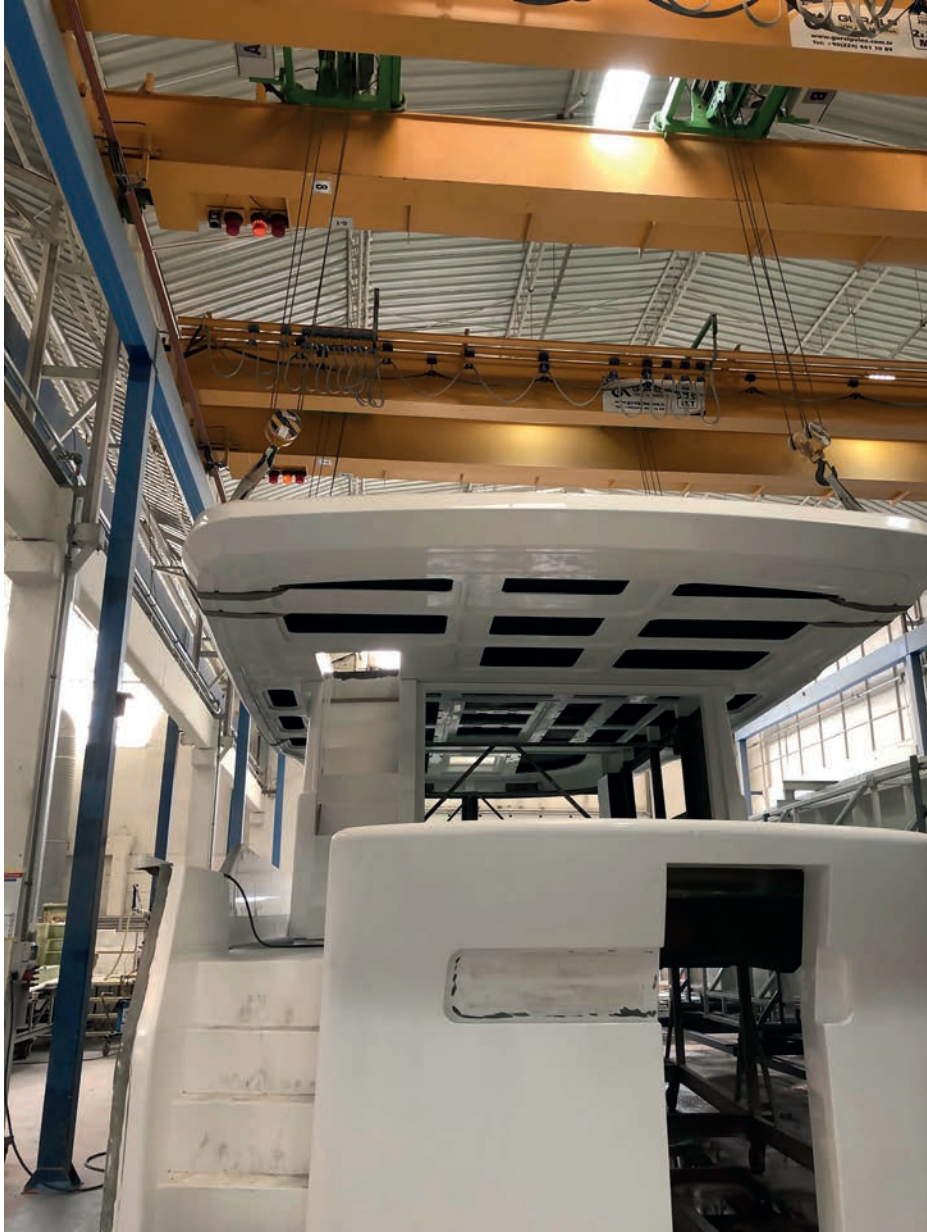
Görsel 9.22: Üst binanın güverteye birleştirilmesi
