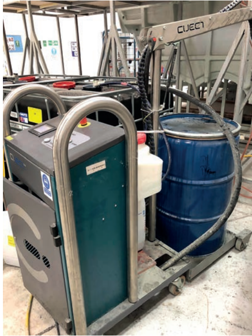
Görsel 6.9: İnfüzyon reçinesi hazırlama ve uygulama makinesi
