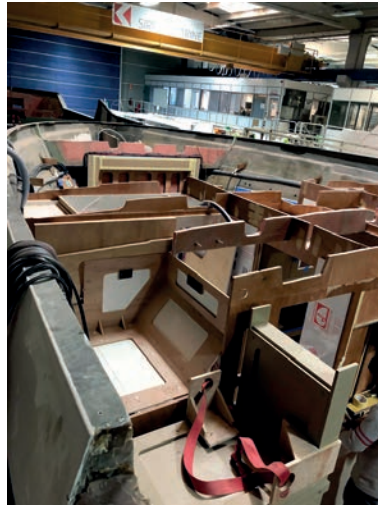
Görsel 5.20: Güverte altının sandviç paneller ile bölümlere ayrılması
