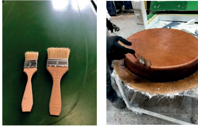
Görsel 4.21: El yatırma yönteminde kullanılan fırçalar ve kullanımı
