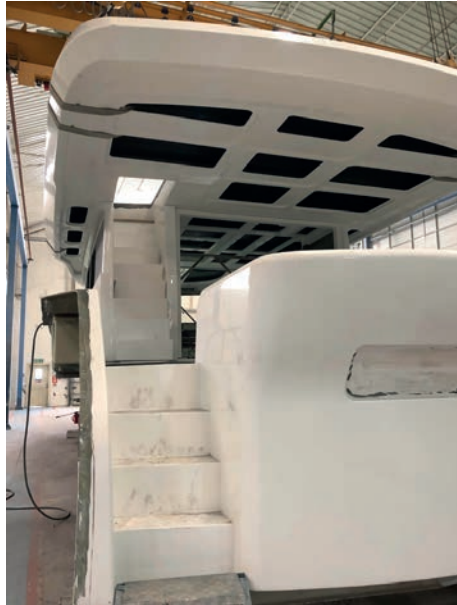
Görsel 8.11: İnfüzyon yöntemiyle imal edilmiş üst bina
