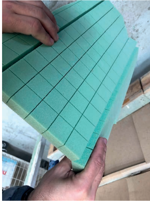
Görsel 5.3: El yatırması uygulamalarında kullanılan PVC köpük
