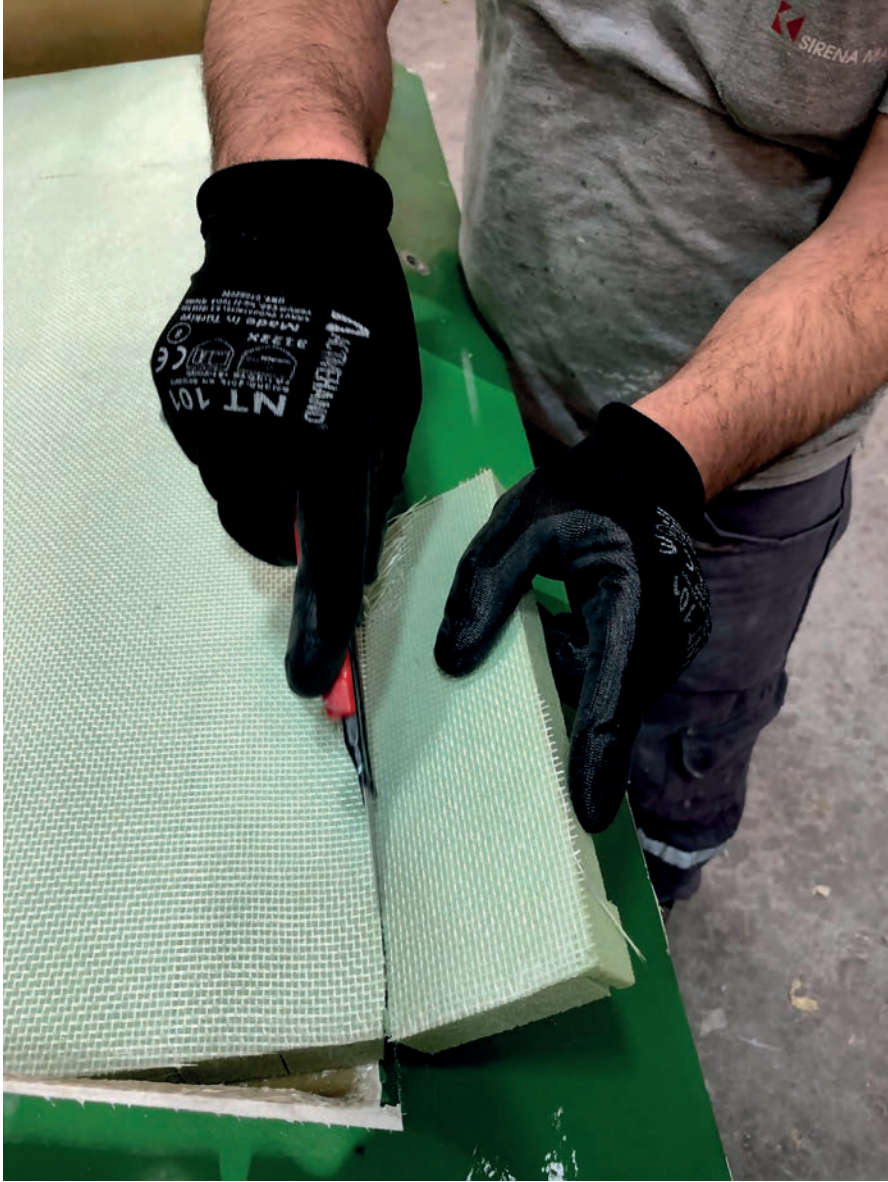
Görsel 5.2: Köpük malzemenin maket bıçağı ile kesimi
