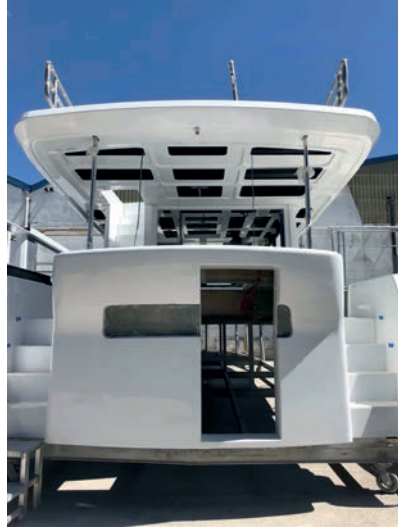
Görsel 8.12: İnfüzyon yöntemi ile imal edilen üst bina
