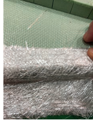
Görsel 5.13: Kenarına pah kırılmış köpük üzerine elyaf serme
