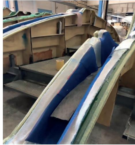
Görsel 6.25: İnfüzyon yöntemiyle imal edilmiş parçalar
