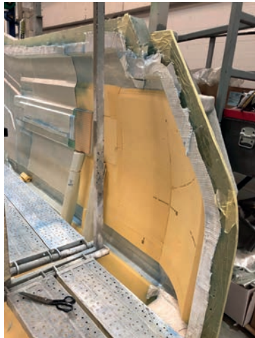
Görsel 5.7: Bordaya düz köpük panel uygulaması
