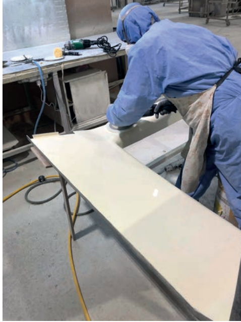
Görsel 10.12: Disk zımpara makinesi ile zımparalama işlemi
