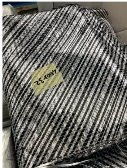
Görsel 4.9: Karbon ve cam iplikleri ile dokunmuş hibrit elyaf
