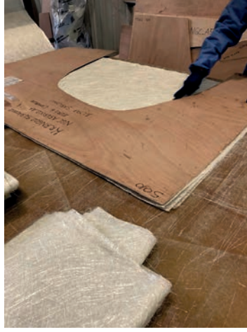
Görsel 4.10: Şablon ile elyaf kesimi
