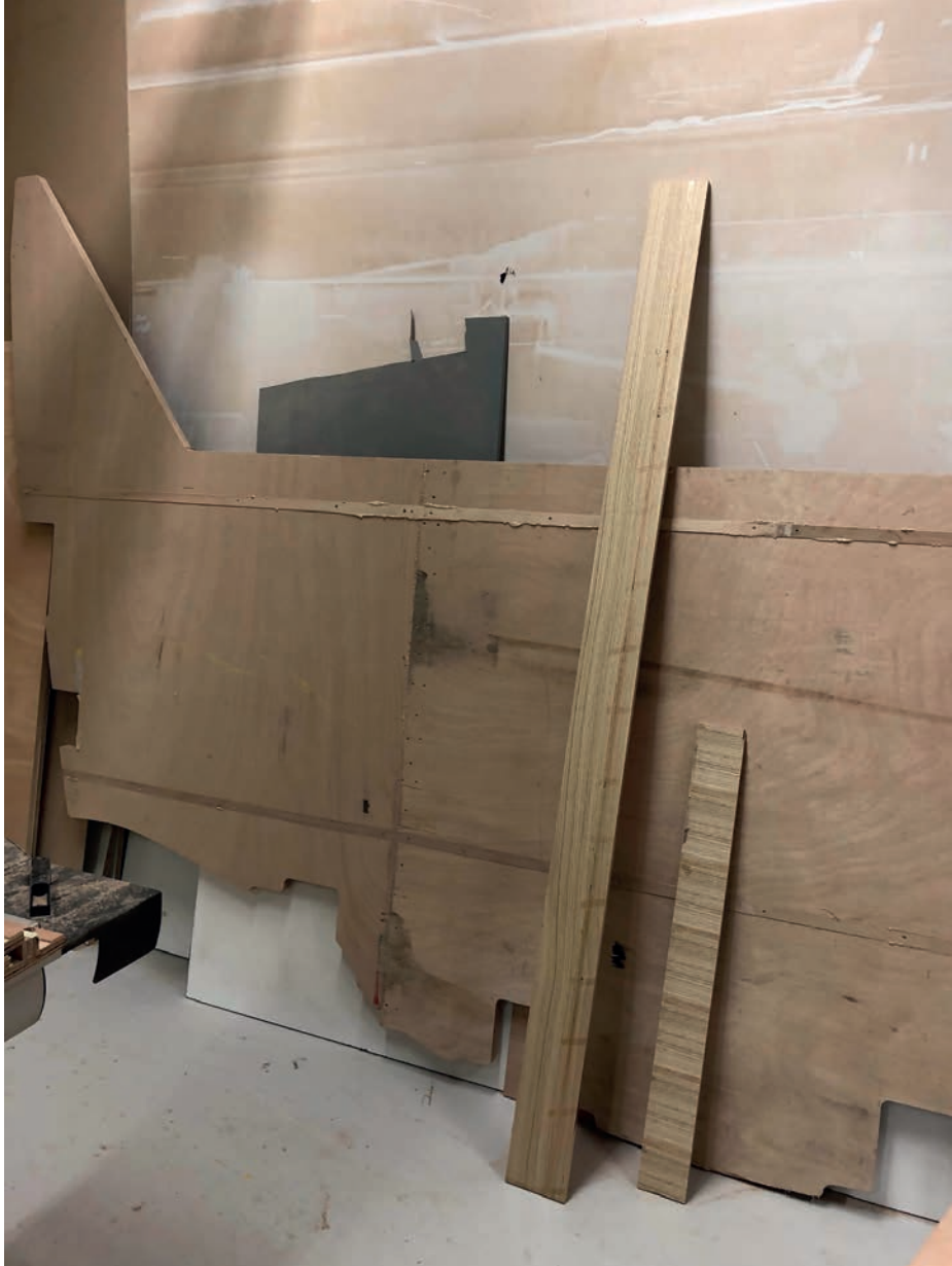
Görsel 5.28: Sandviç panel imalatı için kesilmiş marin kontrplak
