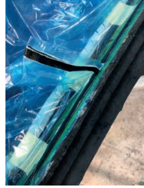
Görsel 5.15: Kalıbın vakum torba yöntemine göre hazırlanması
