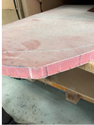
Görsel 5.21: İnfüzyon yöntemiyle imal edilmiş cam elyaf takviyeli sandviç panel
