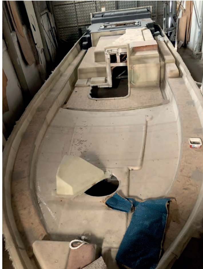
Görsel 3.1: Kompozit kalıbın üretime hazırlanması
