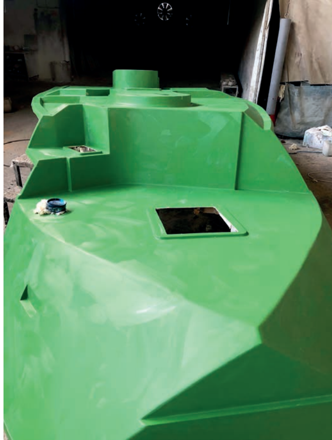
Görsel 7.1: Yat kalıbının yüzey pürüzsüzlüğünün sağlanması
