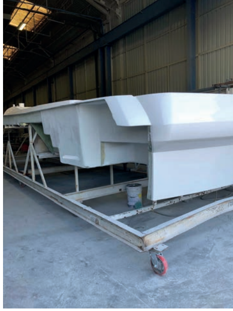
Görsel 1.2: Kompozitten yapılmış yat kalıbı
