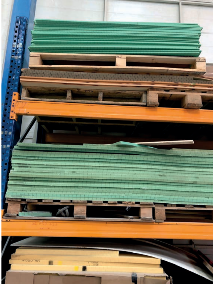
Görsel 5.1: Kompozit tekne ve yat imalatında kullanılan köpük malzemeler
