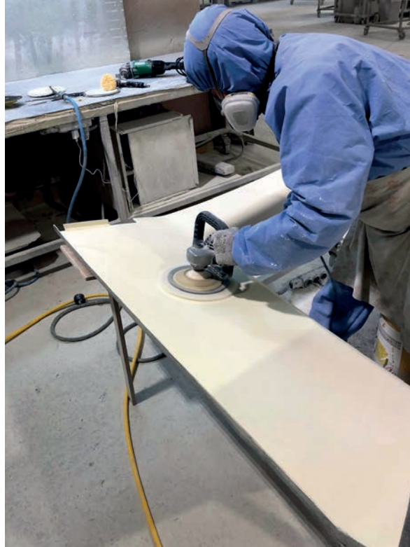
Görsel 10.9: Macun uygulanmış yüzeyin zımparalanması işlemi
