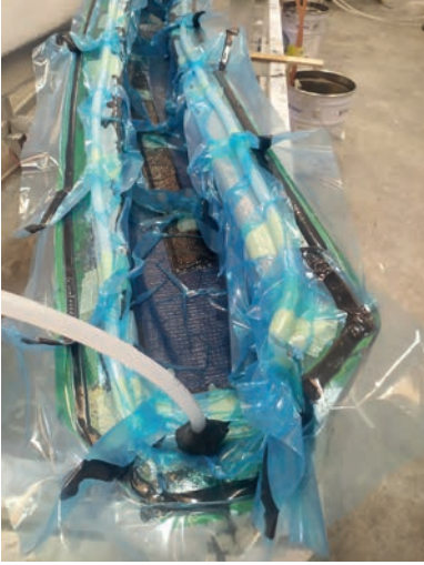
Görsel 6.19: Vakum (bag) torba yöntemiyle parça imalatı
