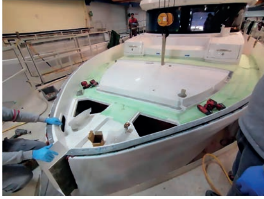
Görsel 9.19: Gövde ile güvertenin birleştirilmesi
