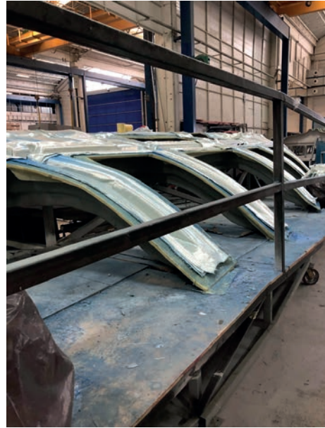
Görsel 8.6: Gövde yapı elemanı spiderin infüzyon yöntemiyle imalatı
