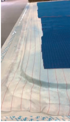
Görsel 5.23: Sarf malzemelerinin yerleştirilmesi
