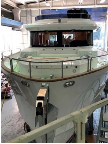
Görsel 9.23: Gövde, güverte ve üst bina montajı
