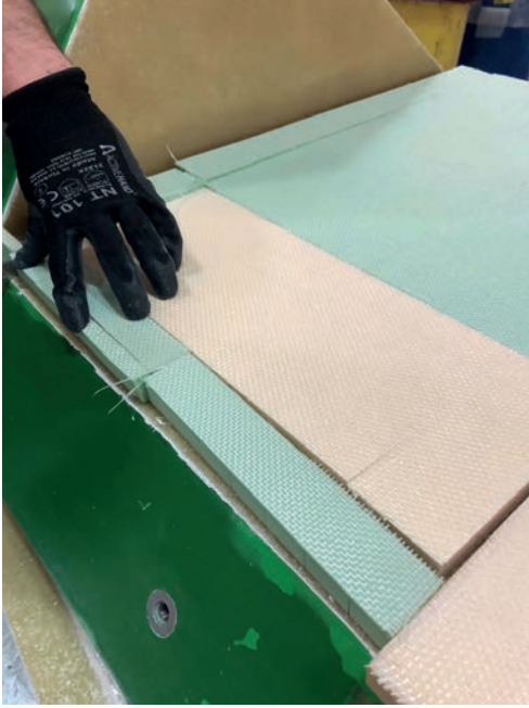
Görsel 5.8: Düz panel köpük uygulaması
