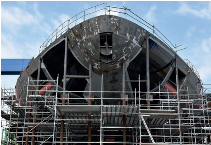
Görsel 5.4: Yapım aşamasındaki buzkıran baş bodoslama
