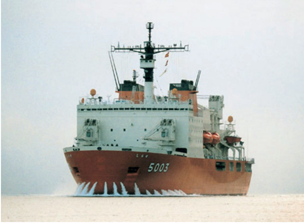
Görsel 5.18: Su püskürten yardımcı sisteme sahip buzkıran
