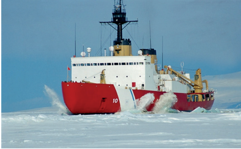
Görsel 5.8: Geminin orta ve kıç bölgesinde buzun kırılması
