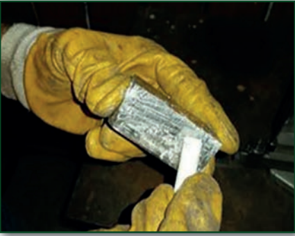
Görsel 2.7: İş parçasının tebeşir ile boyanması
