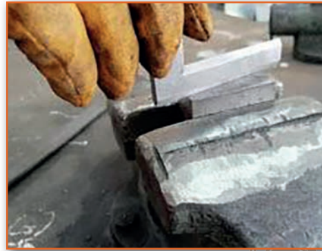
Görsel 3.3: İş parçasının kıl gönye ile boyuna yüzey kontrolü
