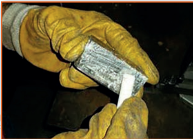
Görsel 3.8: İş parçasının tebeşir ile boyanması
