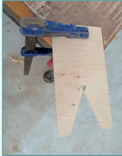
Görsel 7.21: Kıl testere sehпасının marangoz tezgâhına bağlanması
