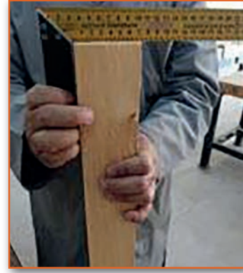
Görsel 3.41: İş parçasının gönye ile kontrolü
