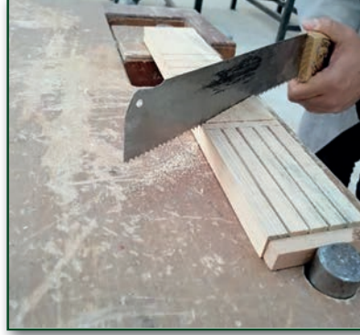
Görsel 2.34: İş parçasının yatay konumda kesilmesi
