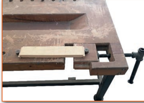
Görsel 3.14: İş parçasının tezgâha bağlanması
