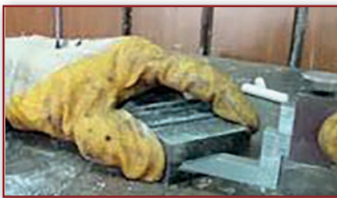
Görsel 4.3: İş parçasının mihengir ile markalanması
