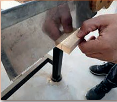
Görsel 3.44: İş parçasının fire kısmına iz yapılması
