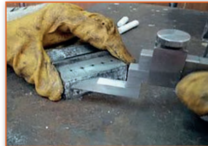
Görsel 3.9: İş parçasının mihengir ile çizilmesi
