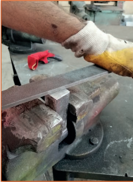
Görsel 3.25: İş parçasının eğelenmesi
