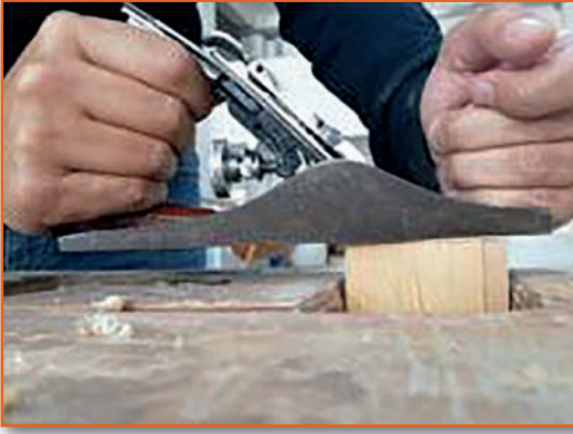
Görsel 3.40: İş parçasının ilk alın kısmının rendelenmesi
