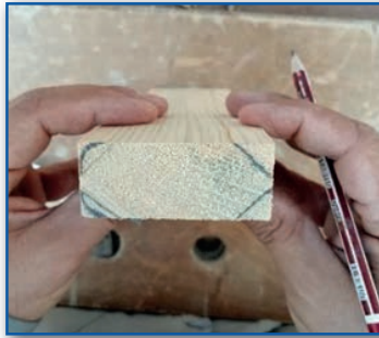
Görsel 5.7: İş parçasının markalanması
