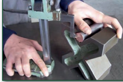
Görsel 2.11: Yuvarlak iş parçasının markalanması
