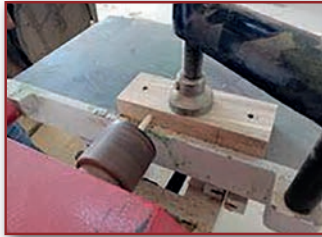
Görsel 4.23: İş parçasının dar yüzünün delinmesi
