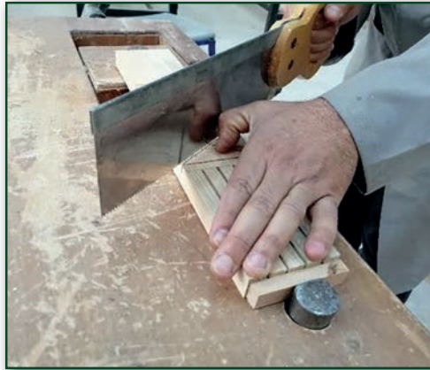
Görsel 2.33: İş parçasına yatay konumda iz yapılması
