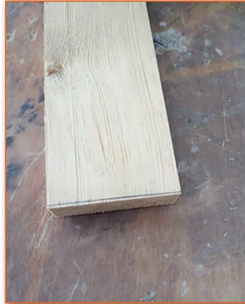
Görsel 3.38: İş parçasının ilk alın kısmının markalanması
