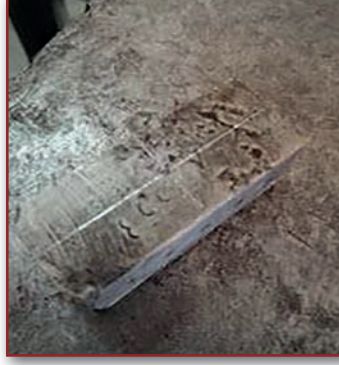
Görsel 4.7: Markalama merkezleri işaretlenmiş parça
