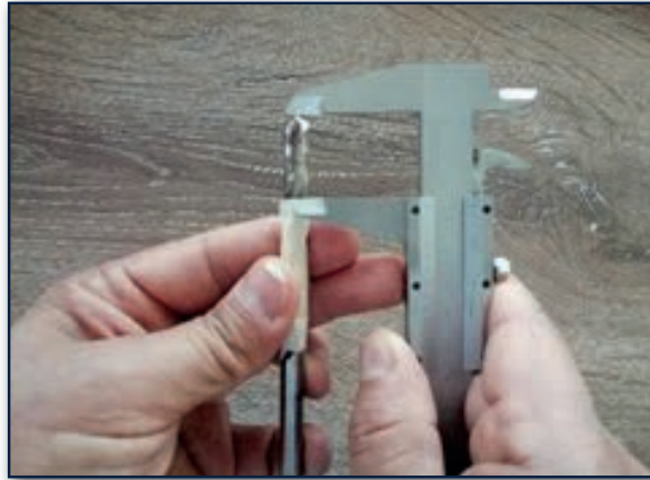
c) Kumpas ile derinlik ölçümü
