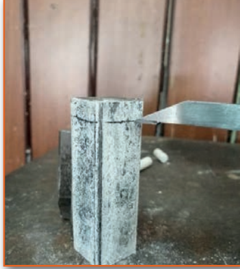
Görsel 3.27: İş parçasının mihengir ile markalanması
