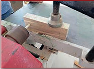
Görsel 4.22: İş parçasının geniş yüzünün delinmesi
