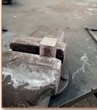
Görsel 3.24: İş parçasının mengeneye bağlanması
