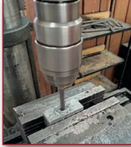
Görsel 4.12: İş parçasının yatay konumda delinmesi
