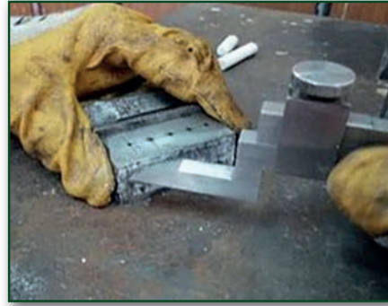
Görsel 2.8: İş parçasının mihengir ile çizilmesi
