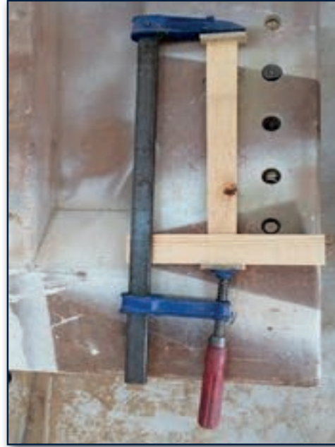
Görsel 1.57: İş parçasının işkence yardımıyla sıkıştırılması
