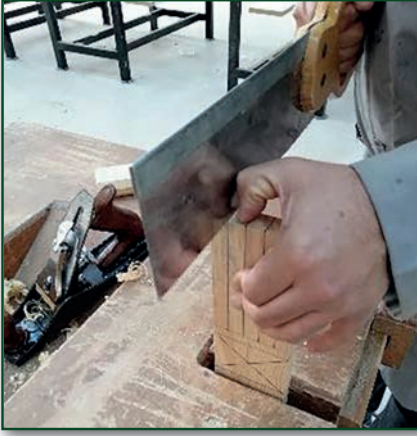
Görsel 2.31: İş parçasına dikey konumda iz yapılması
