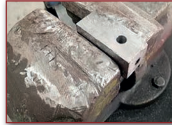
Görsel 4.25: İş parçasının mengeneyle bağlanması
