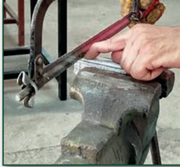
Görsel 2.22: Demir testeresinin iş parçasının üzerine yerleştirilmesi
