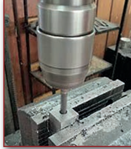
Görsel 4.13: İş parçasının dikey konumda delinmesi
