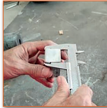
Görsel 3.13: İş parçasının kumpas ile son kontrolü
