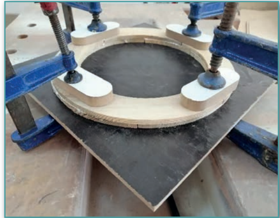
Görsel 7.23: Model parçasının montaj aşamaları
