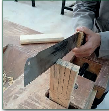
Görsel 2.32: İş parçasının dikey konumda kesilmesi
