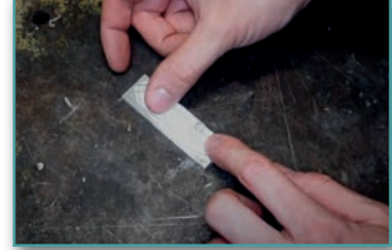
Görsel 7.7: Şablon resminin iş parçası üzerine yapıştırılması
