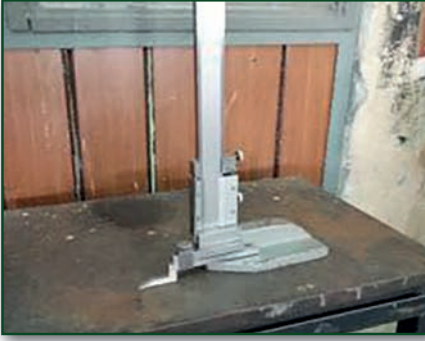
Görsel 2.5: Mihengirin pleyt üzerine yerleştirilmesi
