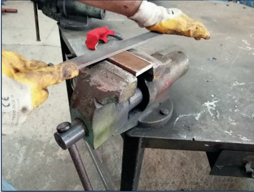
Görsel 1.52: Metal iş parçasını eğleme işlemi
