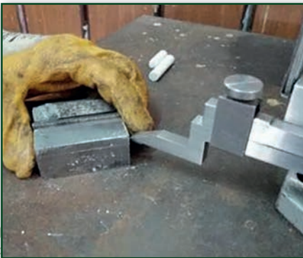
Görsel 2.9: İş parçasının mihengir ile kontrolü
