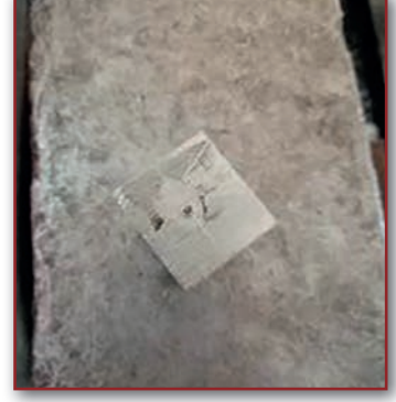
Görsel 4.8: Markalama merkezleri işaretlenmiş parça
