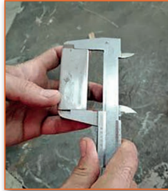
Görsel 3.36: İş parçasının kumpas ile son kontrolü
