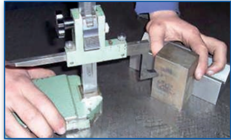
Görsel 5.5: İş parçasının mihengir ile markalanması
