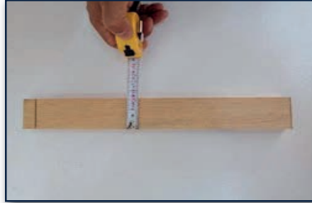
b) Şerit metre ile en ölçümü
