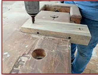
Görsel 4.31: İş parçasına havşa açılması
