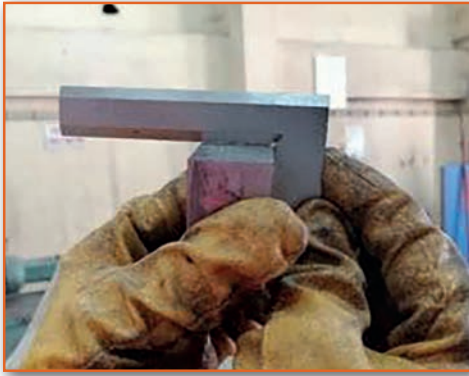
Görsel 3.12: İş parçasının kıl gönye ile son kontrolü
