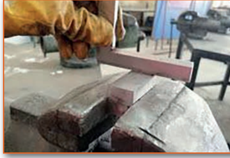
Görsel 3.4: İş parçasının kıl gönye ile enine yüzey kontrolü
