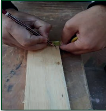
Görsel 2.15: İş parçasının işaretlenmesi
