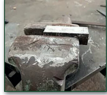
Görsel 2.21: İş parçasının mengeneye bağlanması
