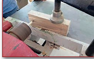
Görsel 4.21: İş parçasının makine tablasına bağlanması
