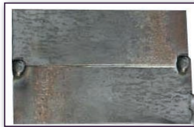
Görsel 6.18: Hatalı çekilmiş punta
