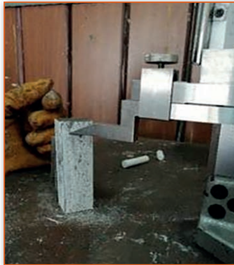
Görsel 3.23: İş parçasının mihengir ile markalanması
