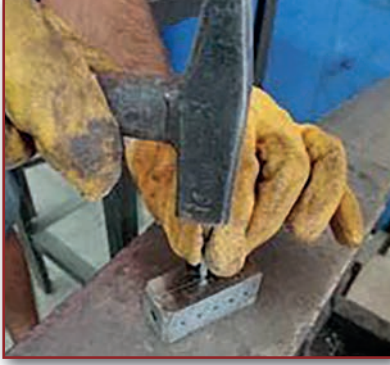
Görsel 4.6: Markalama merkezlerinin nokta ile işaretlenmesi
