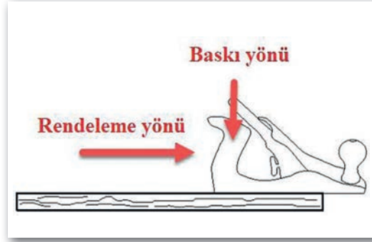
Şekil 3.3: Rende kullanımı (arka baskılama)
