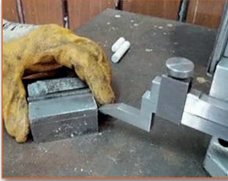
Görsel 3.10: İş parçasının mihengir ile kontrolü
