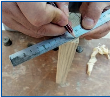
Görsel 5.6: İş parçasının ölçülmesi
