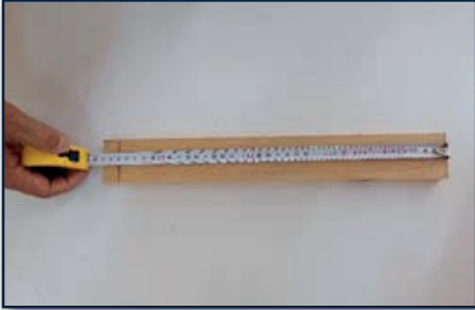
a) Şerit metre ile boy ölçümü
