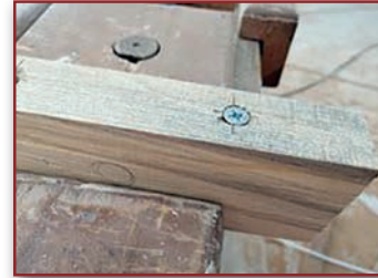
Görsel 4.33: Havşa açılmış iş parçasına vida montajı
