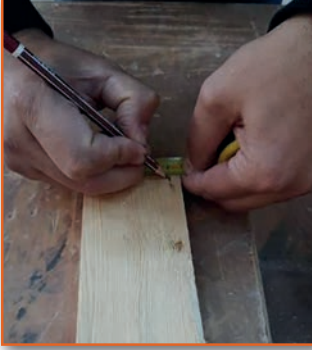
Görsel 3.18: İş parçasının işaretlenmesi
