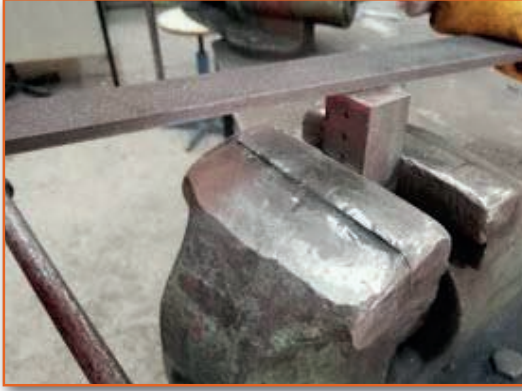
Görsel 3.33: İş parçasının alın kısmının eğelenmesi
