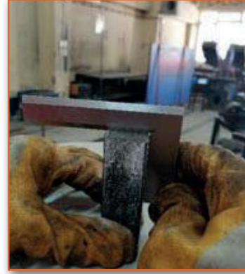
Görsel 3.34: İş parçasının gönye ile kontrolü
