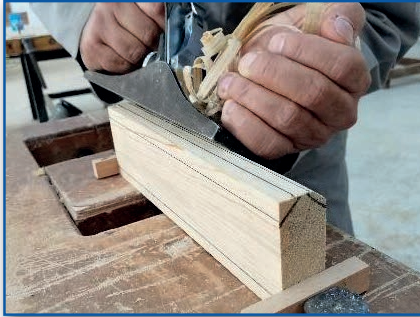
Görsel 5.11: İş parçasına radius açılması
