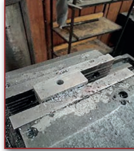
Görsel 4.14: Yatay konumda delinmiş iş parçası
