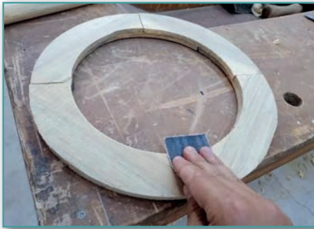
Görsel 7.27: Zımpara ile yüzey temizliği
