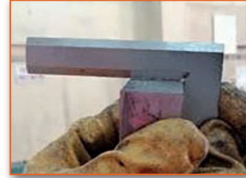
Görsel 3.5: İş parçasının kıl gönye ile yüzey kontrolü
