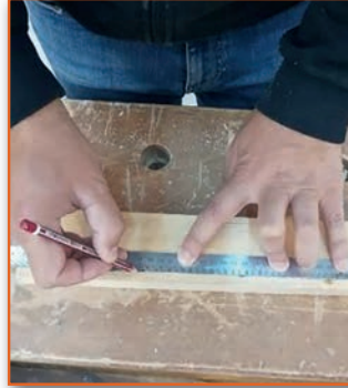
Görsel 3.19: İş parçasının markalanması
