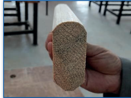
Görsel 5.12: Pah ve radius açılmış iş parçası
