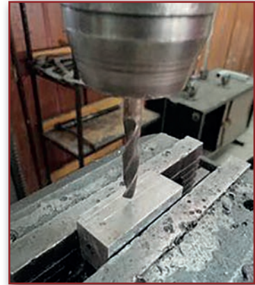
Görsel 4.11: İş parçasının menegeneye bağlanması
