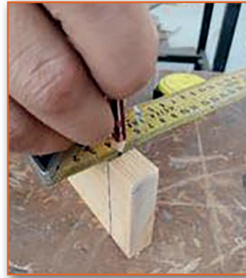
Görsel 3.43: İş parçasının markalanması
