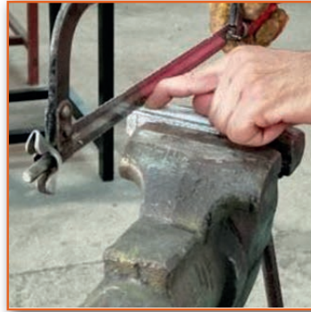
Görsel 3.30: Demir testeresinin iş parçasının üzerine yerleştirilmesi
