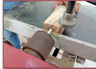
Görsel 4.24: İş parçasının alın kısmının delinmesi
