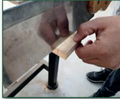
Görsel 2.35: İş parçasının fire kısmına iz yapılması
