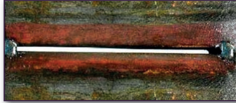
Görsel 6.17: Puntalanan iki parçanın arasındaki mesafe
