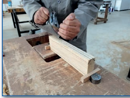
Görsel 5.9: İş parçasının tezgâha bağlanması ve rendelenmesi
