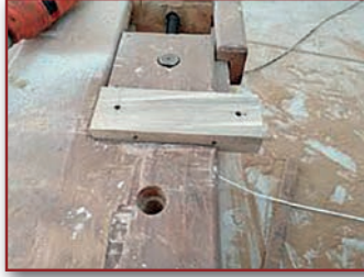
Görsel 4.30: İş parçasının tezgâha bağlanması
