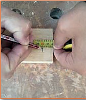
Görsel 3.42: İş parçasının işaretlenmesi
