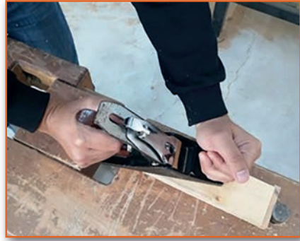
Görsel 3.15: Rendenin ön kısmına baskı uygulanması
