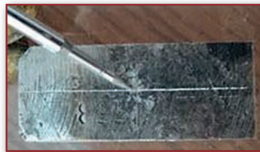
Görsel 4.4: Markalama çizgilerinin belirginleştirilmesi
