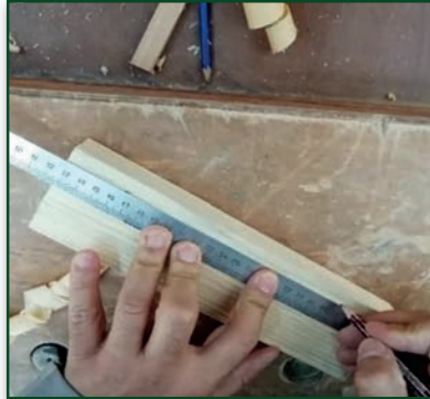
Görsel 2.16: İş parçasının ölçülmesi
