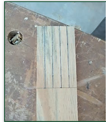
Görsel 2.27: İş parçasının markalanması
