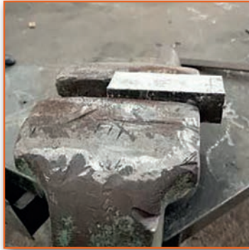
Görsel 3.29: İş parçasının mengeneye bağlanması
