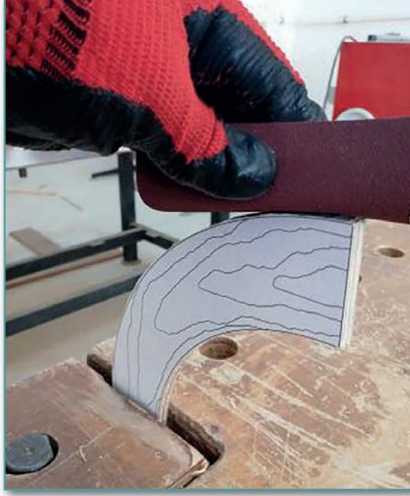
Görsel 7.15: Şablonun kenar fazlalıklarının zımpara ile düzeltilmesi
