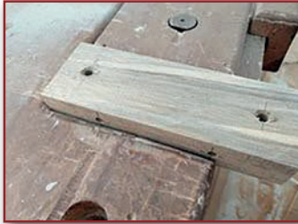
Görsel 4.32: Havşa açılmış iş parçası
