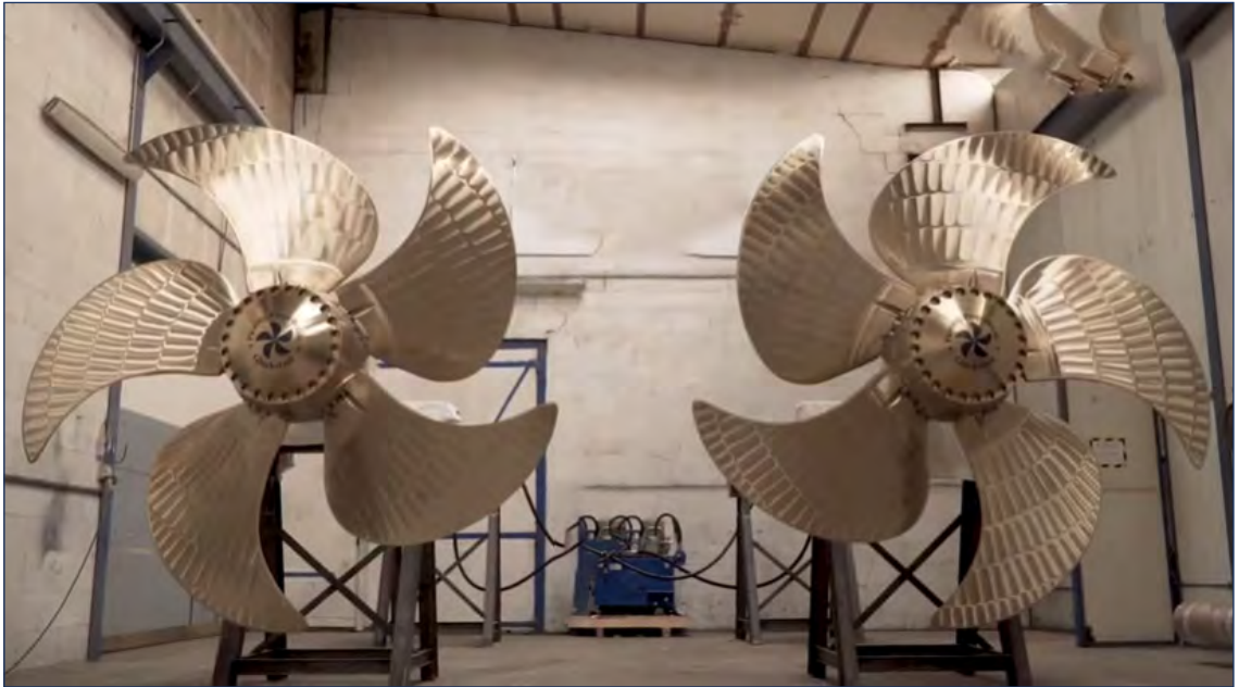
Görsel 2.6: Sola dönüşlü ve sağa dönüşlü pervane
