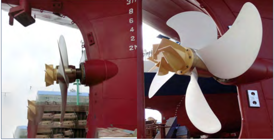
Görsel 2.38: Kış itici fiber karbon pervane
