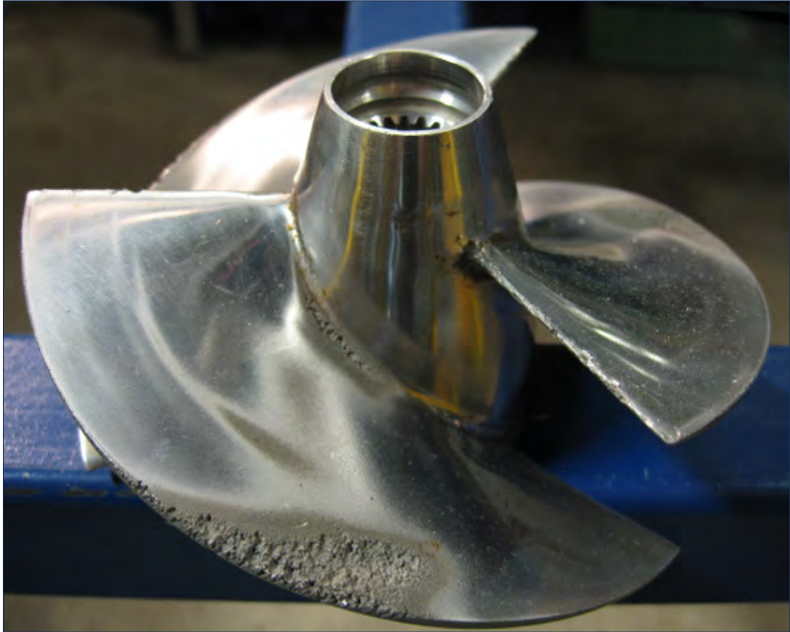
Görsel 2.9: Kavitasyon hasarına uğramış pervane
