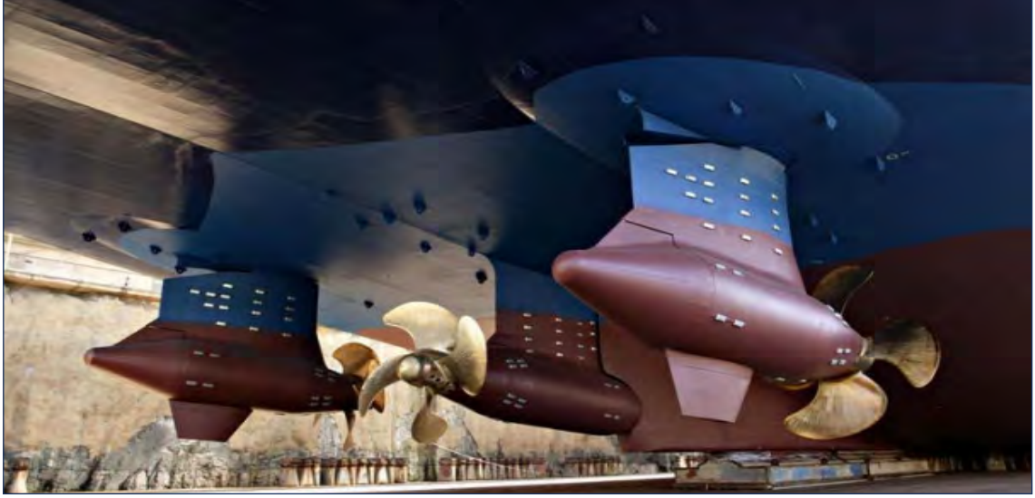
Görsel 1.27: Pervanelerin dönerek dümen olarak kullanılması
