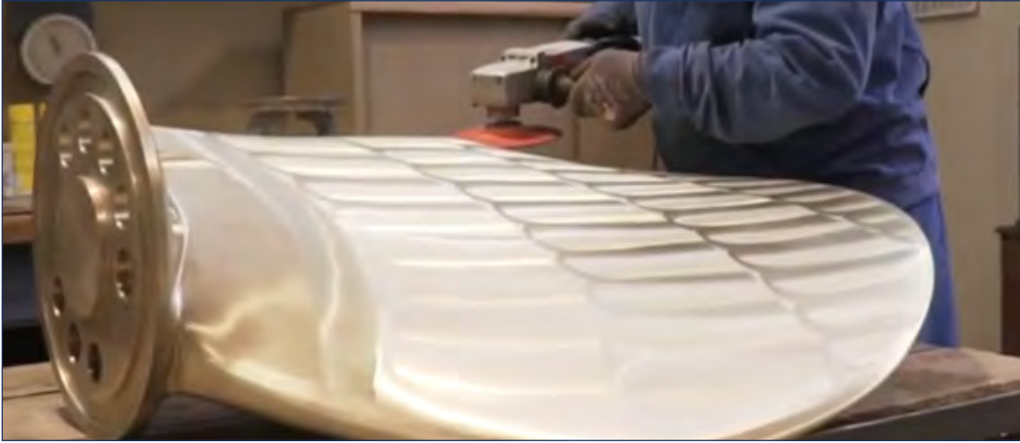
Görsel 2.43: Pervane kanadı son hazırlık işlemleri
