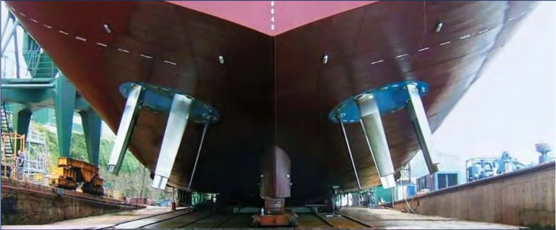
Görsel 2.33: Voith Schneider pervanesinin gemi üzerinde görünüşü
