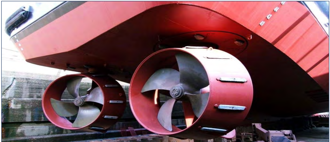
Görsel 2.22: İki adet nozullu pervane takılmış gemi
