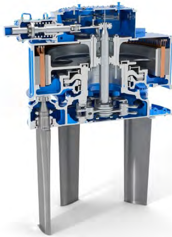
Görsel 1.61: Voith Schneider pervanesinin iç mekanizması
