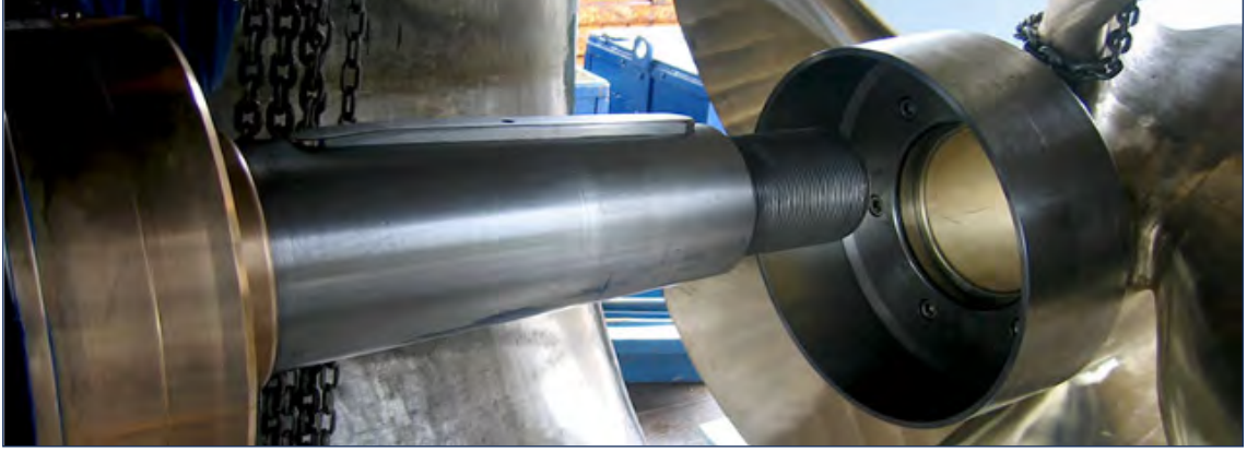
Görsel 2.41: Yekpare pervane montajı
