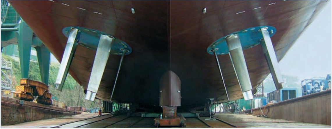
Görsel 1.62: Römorkör gövdesinde konumlandırılmış ikiz Voith Schneider pervane
