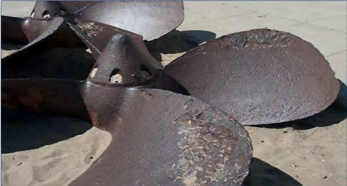
Görsel 2.8: Kavitasyon hasarına uğramış pervaneler
