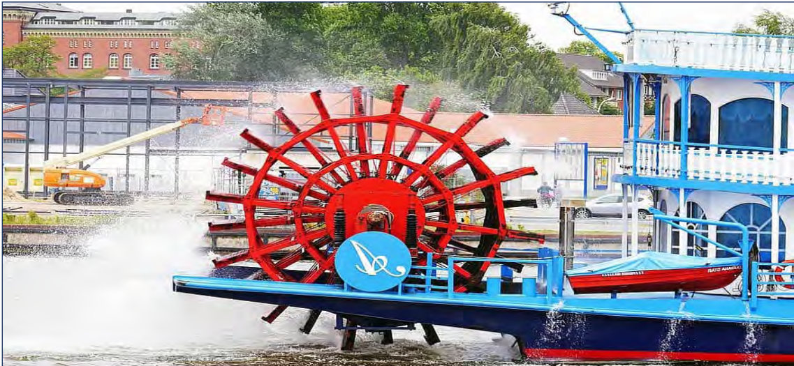
Görsel 1.35 : Kıç tarafa monte edilmiş padıl çark
