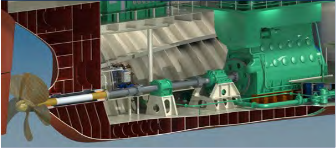
Görsel 1.13: Pervane, şaft ve ana makineden oluşan sevk sisteminin gemi modelinde gösterilmesi
