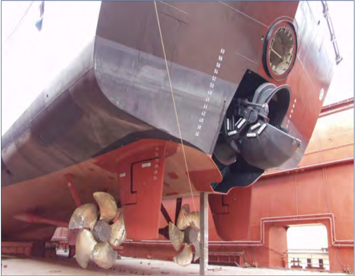
Görsel 1.69: Aynı gemide su jeti ve pervane sistemi
