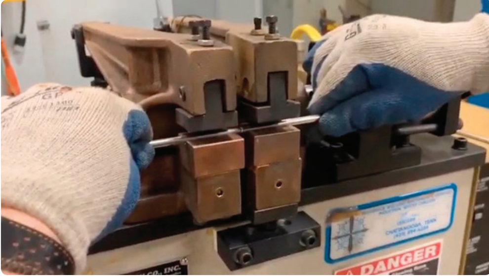
Görsel 2.4: Direnç alın kaynak makinesine parçaların konumlandırılması
